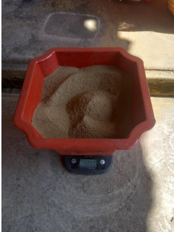
Figura 10. Pesado del suelo contaminado de Sincos
