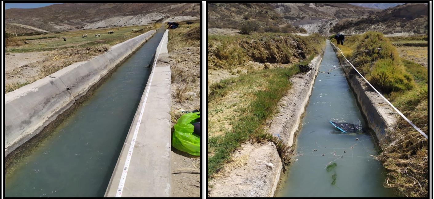
SE REALIZA MEDIDAS PARA EL AFORO DEL CAUDAL POR EL METODO DEL FLOTADOR
