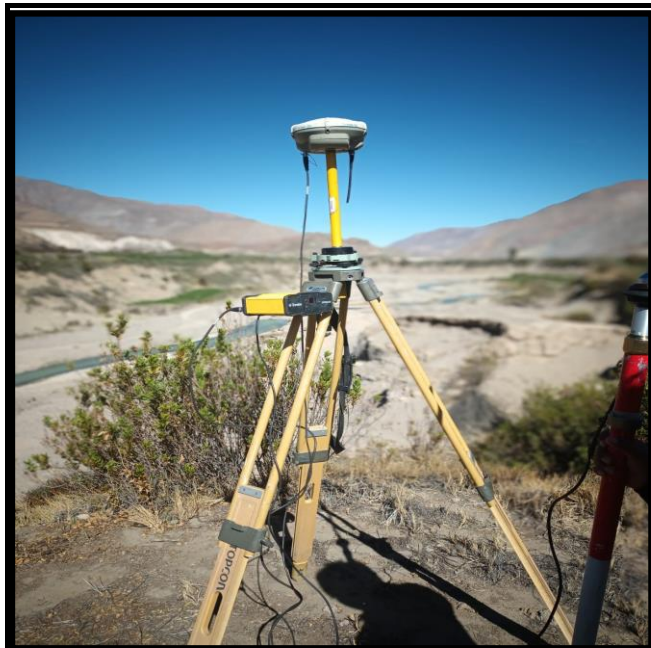
LEVANTAMIENTO TOPOGRAFICO CON GPS DIFERENCIAL MARCA TRIMBLE MODELO R8 - N3
