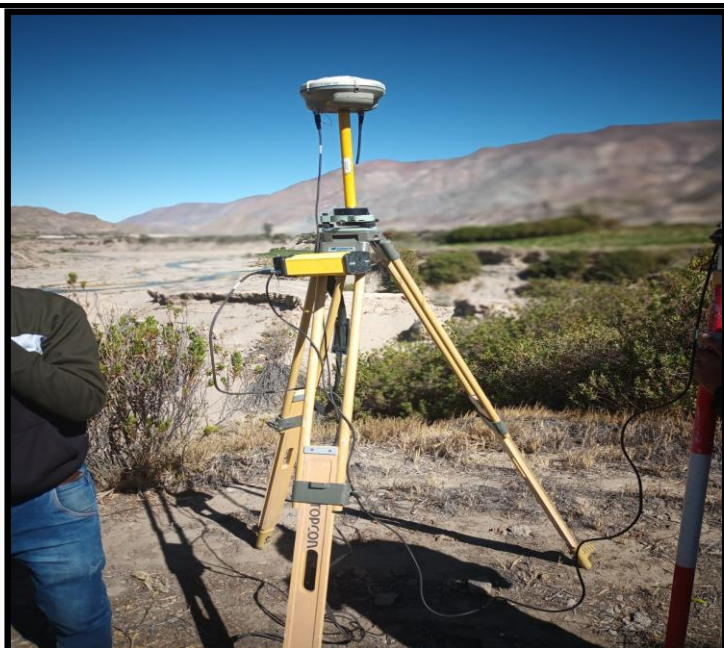
LEVANTAMIENTO TOPOGRAFICO CON GPS DIFERENCIAL MARCA TRIMBLE MODELO R8 - N3
