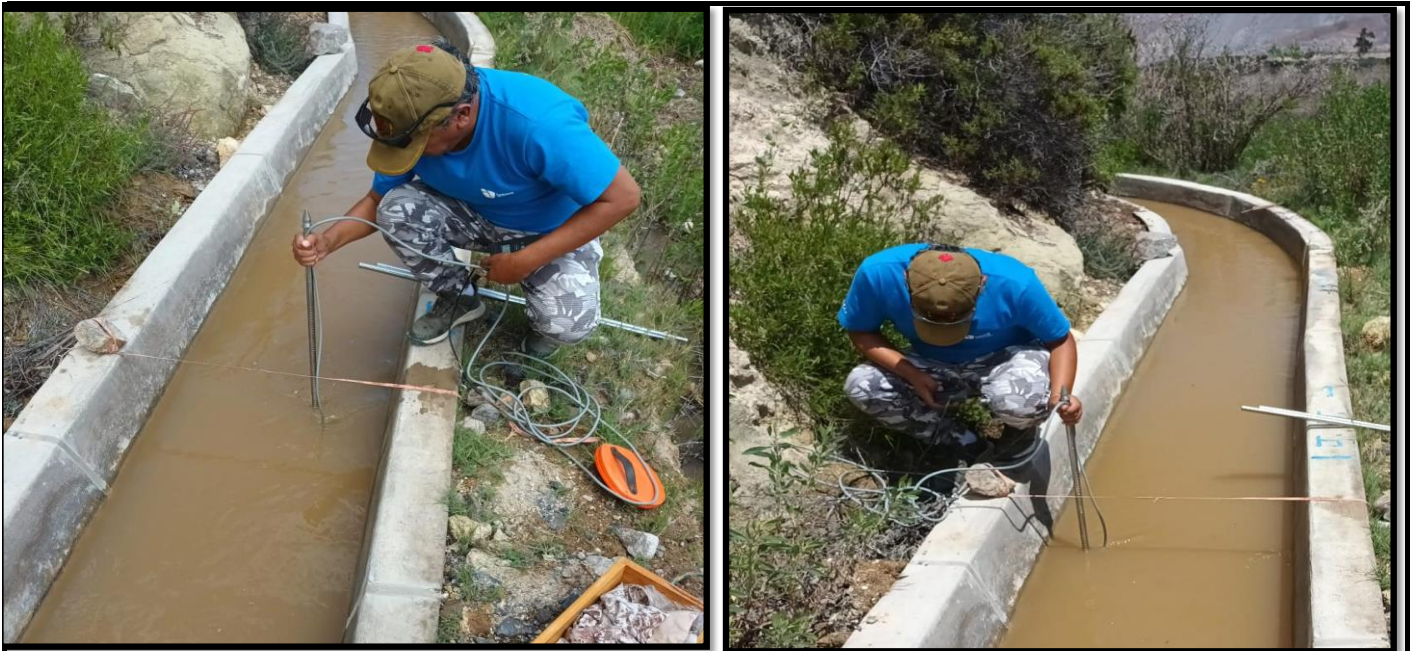
PROGRESIVA 005+200 AFORO DE CAUDAL CON CORRENTOMETRO SIAP - 03 HELICES
