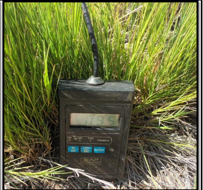
PROGRESIVA 004+700 AFORO DE CAUDAL CON CORRENTOMETRO SIAP - 03 HELICES
