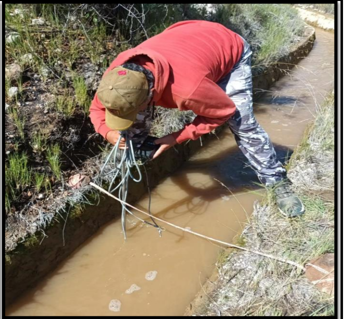
PROGRESIVA 004+200 AFORO DE CAUDAL CON CORRENTOMETRO SIAP - 03 HELICES
