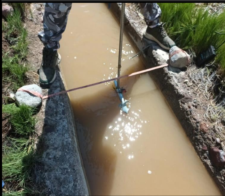
PROGRESIVA 004+700 AFORO DE CAUDAL CON CORRENTOMETRO SIAP - 03 HELICES
