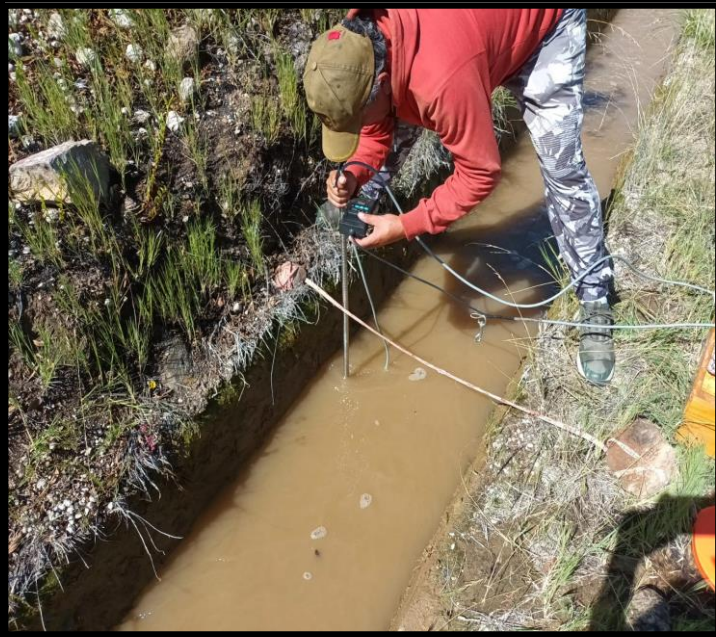
PROGRESIVA 004+200 AFORO DE CAUDAL CON CORRENTOMETRO SIAP - 03 HELICES
