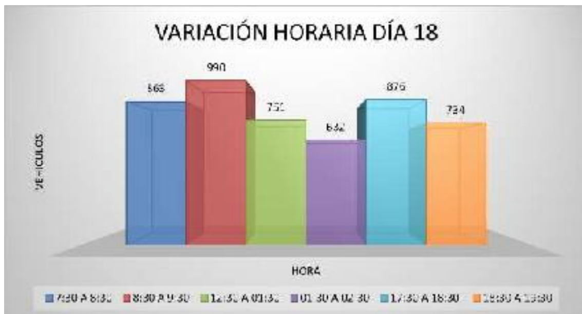
Figura 148 - Fluctuación horaria en el cruce semaforico de la Avenida Andahuaylas y Jirón Ramón Castilla.
