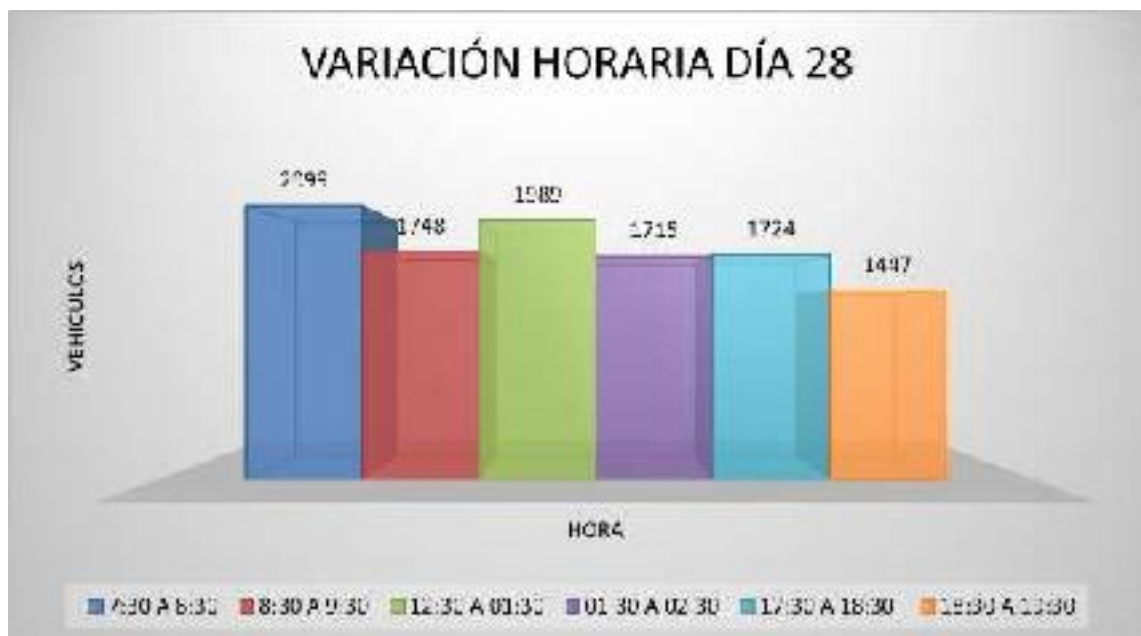
Figura 126 - Fluctuación horaria en el cruce semafórico de la Avenida Martinelli, Avenida Perú y Jirón Ramón Castilla.
