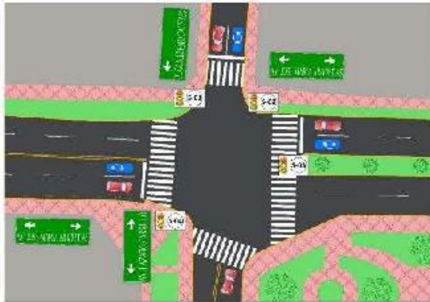
Figura 48 - Codificación de semáforos del cruce semafórico de la Avenida José María Arguedas, Avenida Lázaro Carrillo y Jirón Guillermo Caseres.
