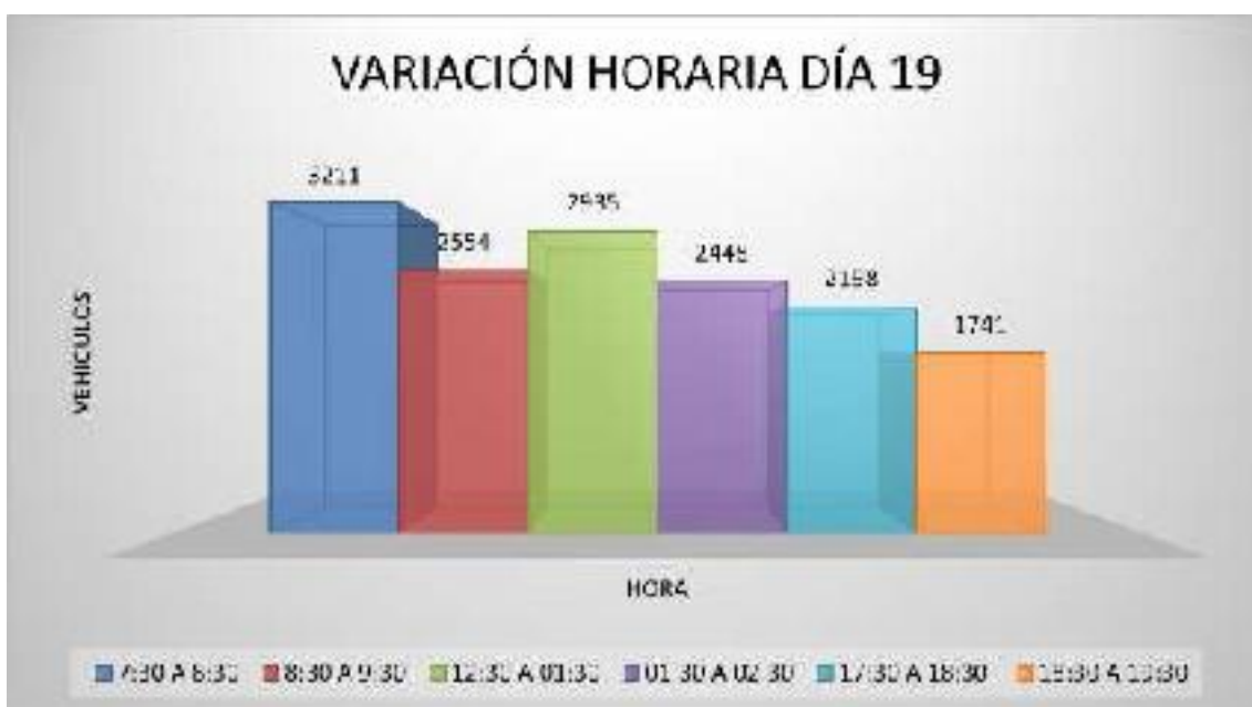
Figura 85 - Fluctuación horaria en el cruce semafórico de la Avenida José María Arguedas, Avenida El Ejército y Avenida Martinelli.
