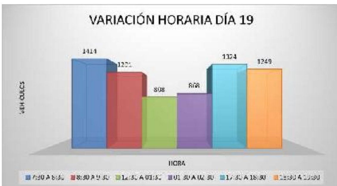
Figura 149 - Fluctuación horaria en el cruce semafórico de la Avenida Andahuaylas y Jirón Ramón Castilla.
