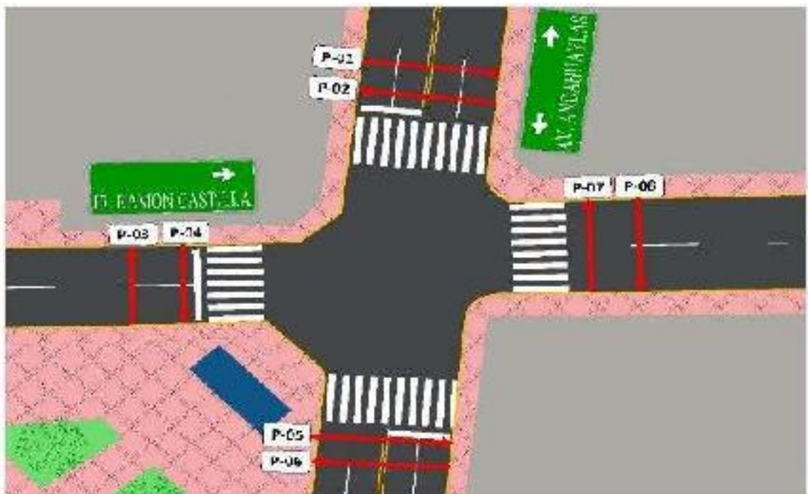
Figura 30 - Codificación de desplazamiento peatonal en el cruce semafórico de la Avenida Andahuaylas y Jirón Ramón Castilla.
