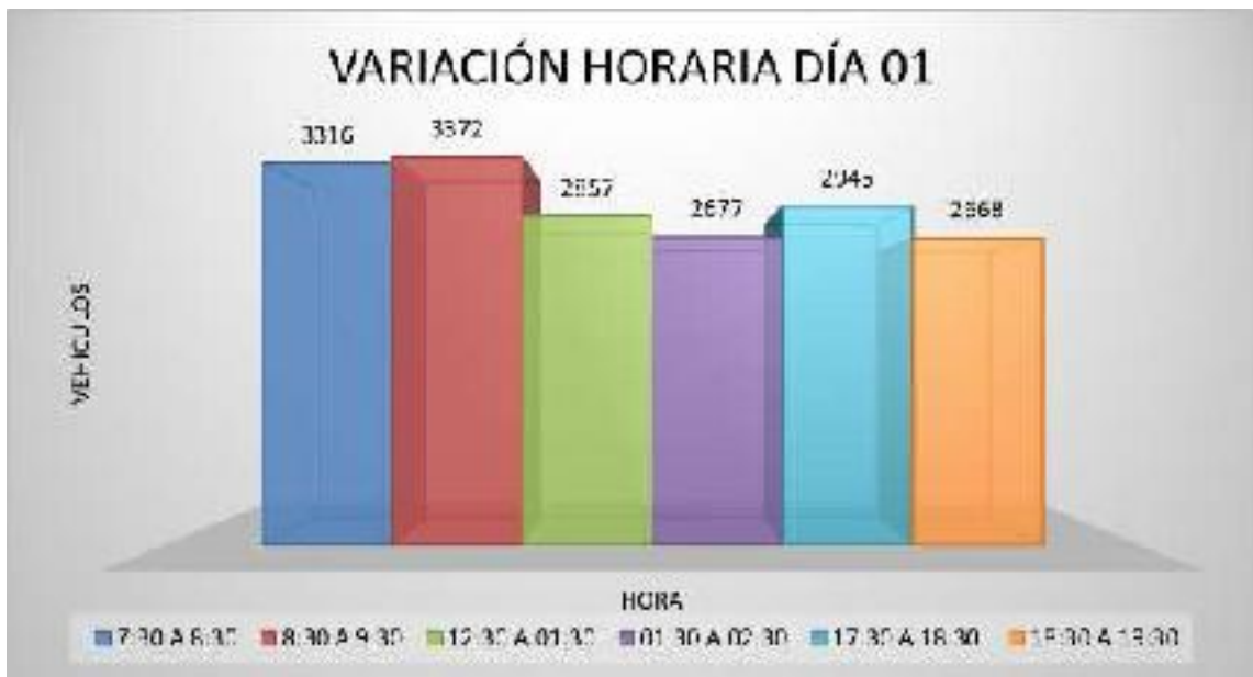
Figura 65 - Fluctuación horaria en el cruce semafórico de la Avenida José María Arguedas, Avenida Lázaro Carrillo y Jirón Guillermo Caseres.
