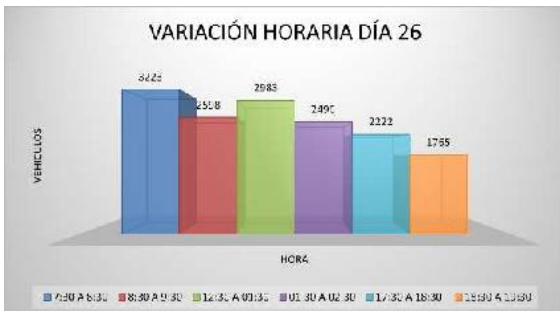
Figura 92 - Fluctuación horaria en el cruce semafórico de la Avenida José María Arguedas, Avenida El Ejército y Avenida Martinelli.
