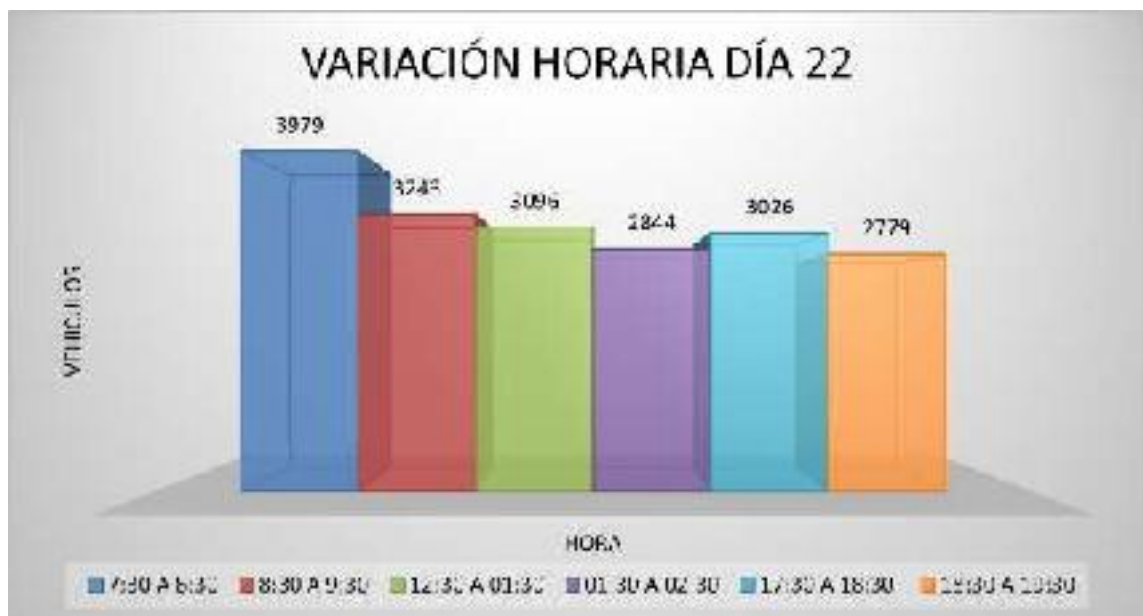
Figura 56 - Fluctuación horaria en el cruce semafórico de la Avenida José María Arguedas, Avenida Lázaro Carrillo y Jirón Guillermo Caseres.
