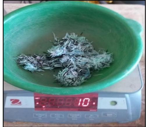
3.8 ELABORACIÓN DE LAS MUESTRAS DE CONCRETO DE  $f'c=210\text{kg/cm}^2$  DE MUESTRAS PATRÓN: 0%, 0.1%, 0.15%, 0. 20%, 0.25% Y EXPERIMENTAL EN VOLUMEN, UTILIZANDO PROBETAS CILÍNDRICAS PARA LA RESISTENCIA A LA COMPRESIÓN SIMPLE Y PROBETAS PIRAMIDALES PARA LA RESISTENCIA A LA FLEXIÓN.
