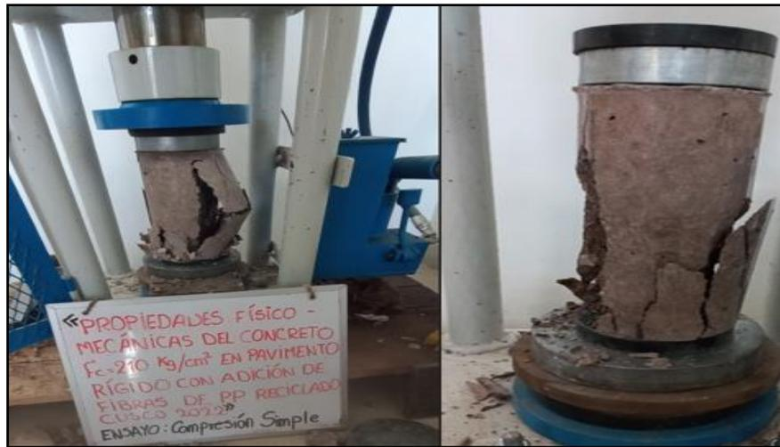
**FIGURA 13.** Ruptura de testigos cilíndricos
