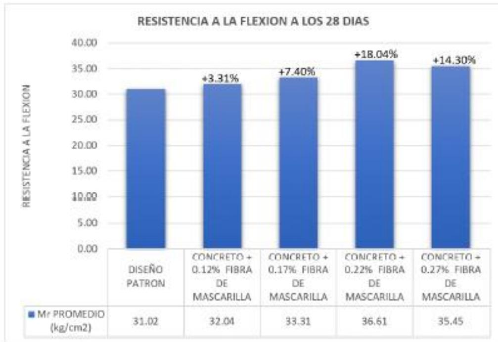
**FIGURA 34.** Resistencia a la flexión los 28 días del concreto  $f^c=210$  kg/cm<sup>2</sup> incorporando fibras de polipropileno recicladas de mascarillas faciales
