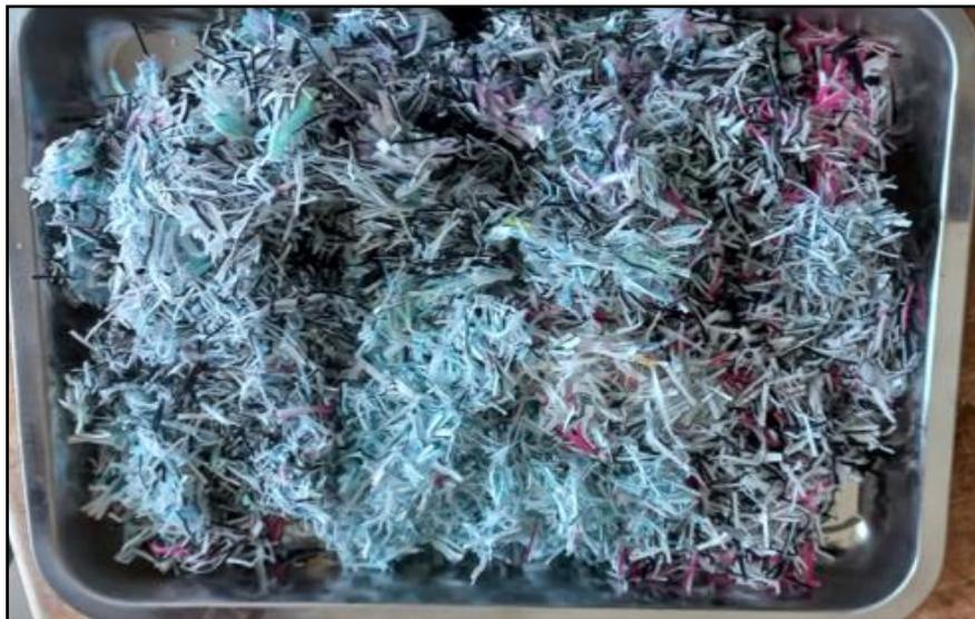
**FIGURA 10.** Triturado de fibras de polipropileno reciclados
