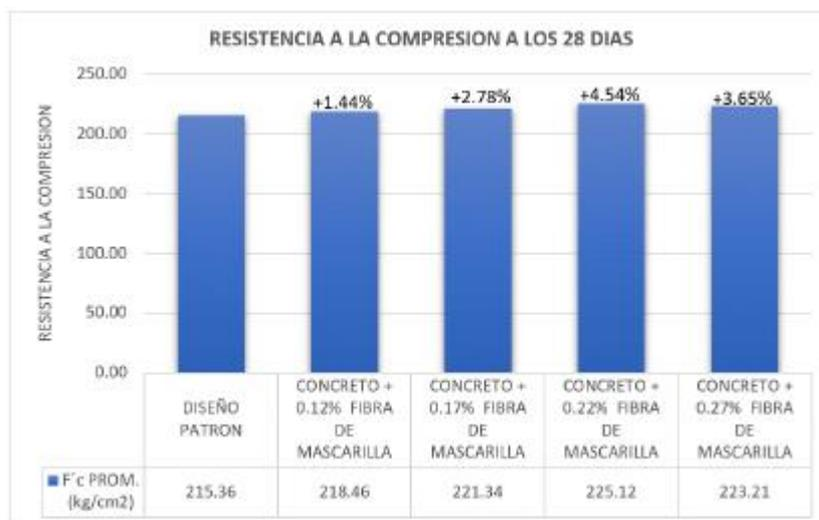
**FIGURA 32.** Resistencia a la compresión a los 28 días del concreto  $f'c=210$  kg/cm<sup>2</sup> incorporando fibras de polipropileno recicladas de mascarillas faciales
