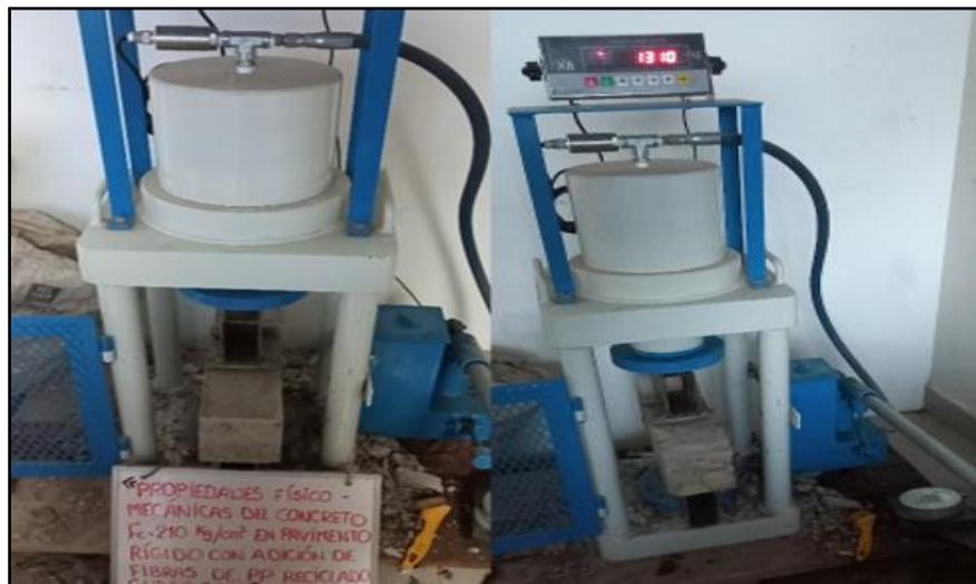
**FIGURA 14.** Ruptura de testigos Prismáticos
