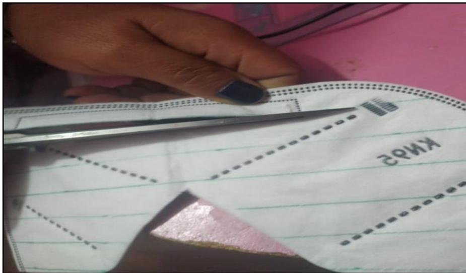
3.5 CORTE DE LAS FIBRAS DE POLIPROPILENO RECICLADO DE MASCARILLAS FACIALES, GORRAS Y BATAS DE PP
