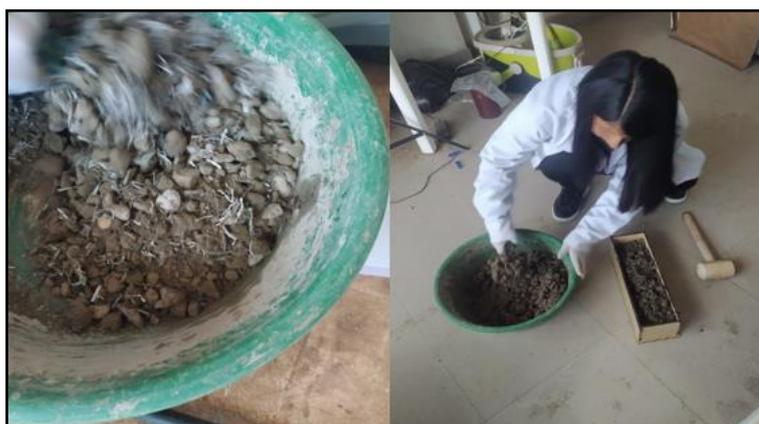
**FIGURA 11.** Elaboración de testigos de concreto
