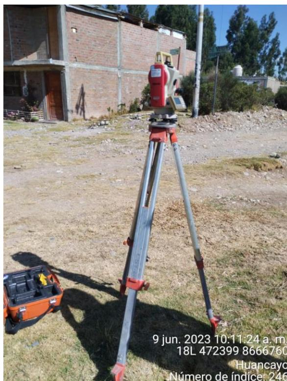
Figura N° 9. Nivelación la Estación total. Elaboración Propia
