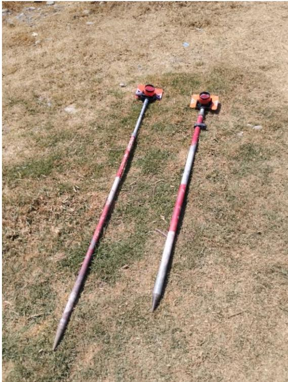
*Figura N° 11.* Prismas con jalón usados en el levantamiento topográfico. Elaboración Propia
