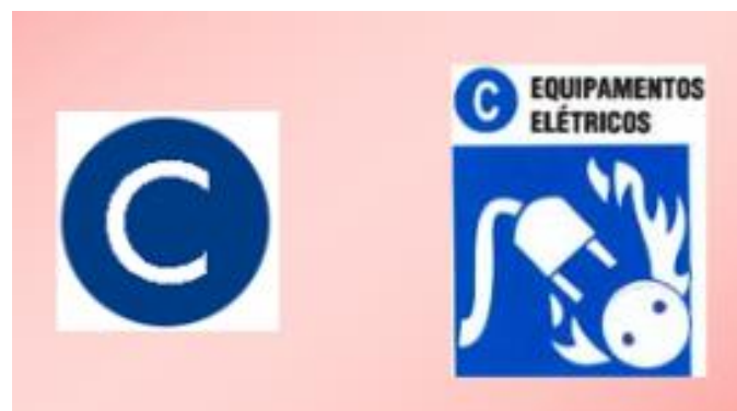
Figura 4. Simbología de Clase de Fuego tipo C. Tomado de “Curso básico de extintores Portátiles”, por Castillo, 2013, p.22.
