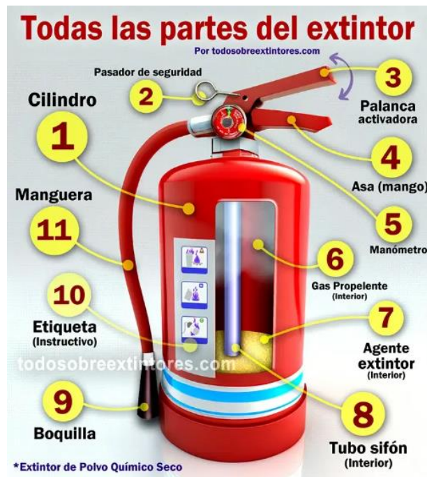
Figura 8. Partes de un extintor de PQS. Tomado de “Conociendo las partes de un extintor”, por TODO SOBRE EXTINTORES Y SEGURIDAD INDUSTRIAL S.A.C, 2024, p.1.
