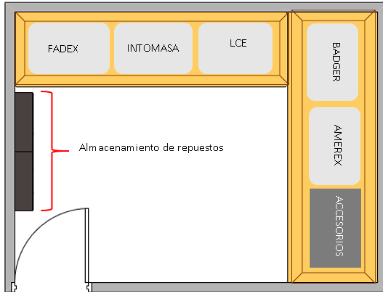
Figura 32. Layout propuesto para la organización de extintores nuevos, repuestos y accesorios.
