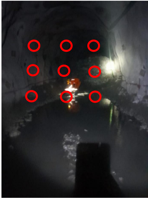
Figura 13. Levantamiento de ventilación de una labor subterránea.
