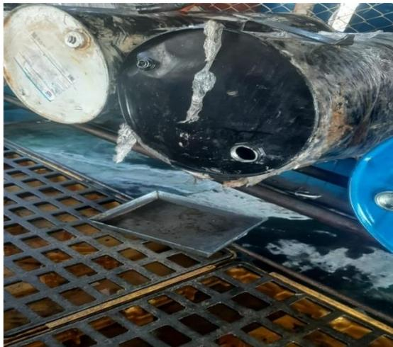
*Figura 6. Cilindros de aceite expuestos a la contaminación y derrames*
