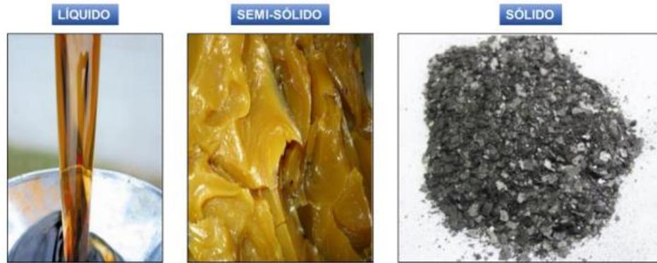
*Figura 9. Tipos de lubricante según estado
