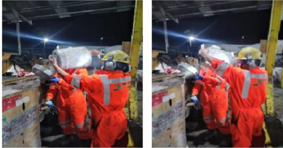
*Figura 7. Llenado de aceite a los componentes de equipo*
