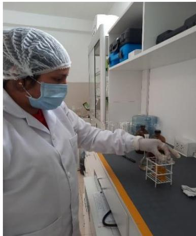
*Figura 8. Preparación de viales para la medida de DQO*
