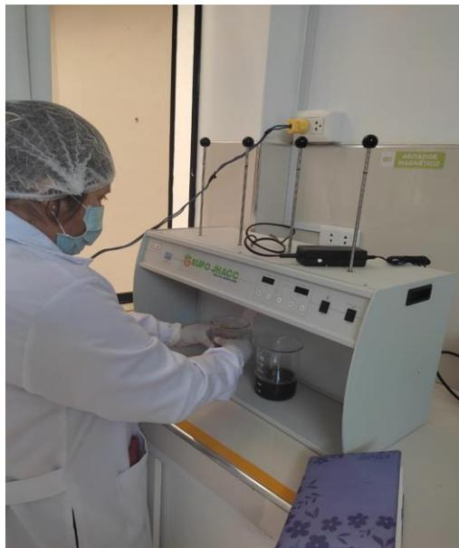
*Figura 10. Tratamiento del lixiviado en la prueba de jarras*
