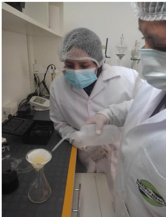
Lavado de resinas con agua destilado
