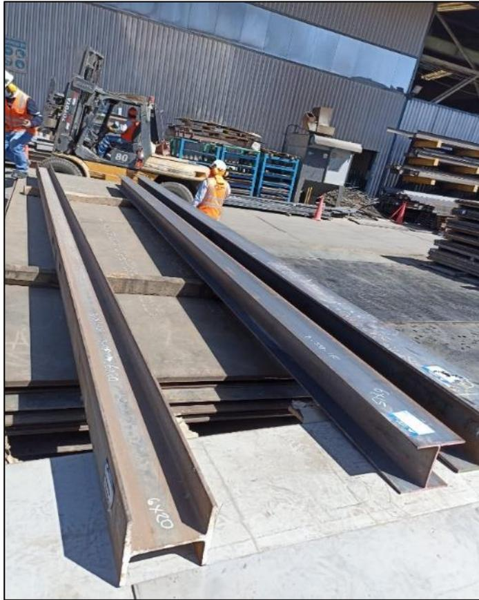
*Figura 13. Perfiles W ingresados a planta para la fabricación de los equipos Hydrofloat y Crossflow*
