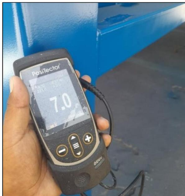
*Figura 25. Medida indicada en el positector según el espesor de pintura, la medida indica 7 mills*
