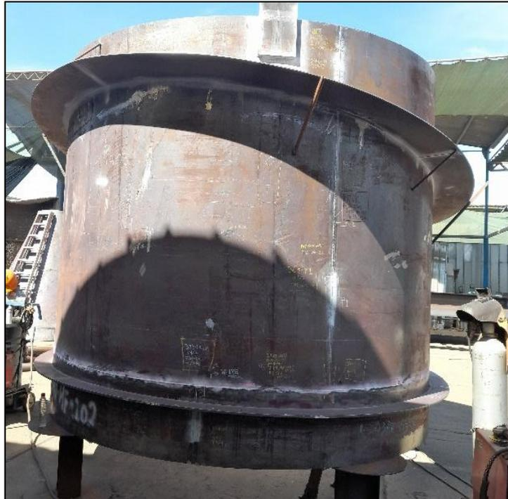
*Figura 18. Ejecución de las pruebas NDT (líquidos penetrantes) durante el proceso de armado*
