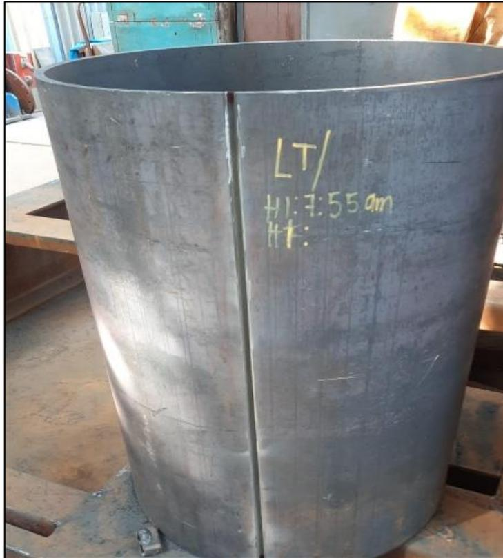
*Figura 16. Verificación de la parte ensamblada antes de ser soldada*
