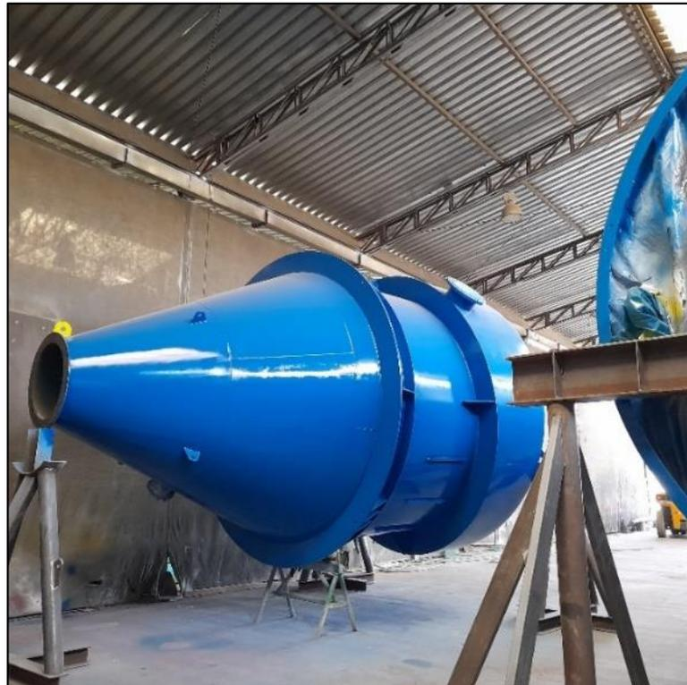
*Figura 24. Inspección del equipo al finalizar el curado del recubrimiento*
