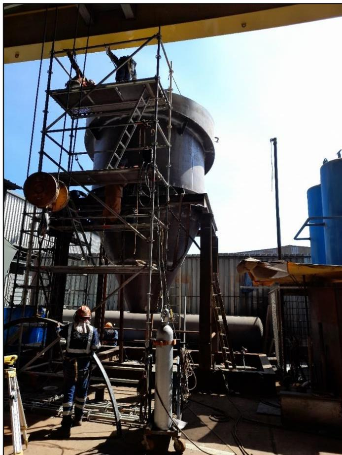
*Figura 9. Celda de flotación al 90 % de avance de fabricación*
