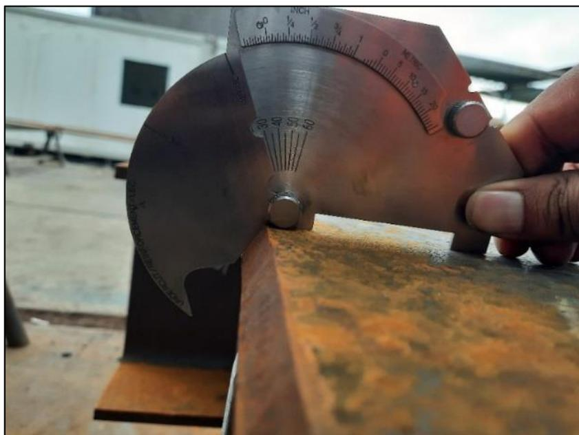
***Figura 15. Inspección de la preparación de junta***
