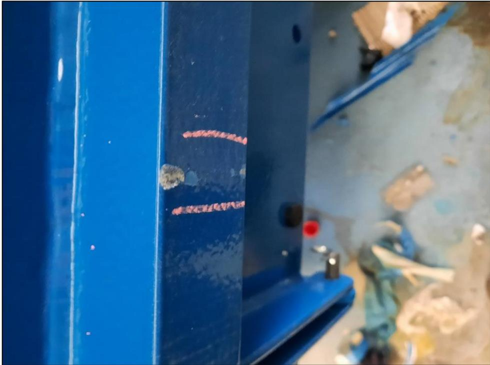
*Figura 22. Daños encontrados durante la inspección de pintura*
