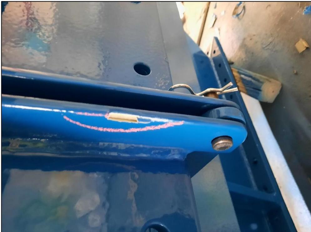
*Figura 23. Daños encontrados durante la inspección de pintura*
