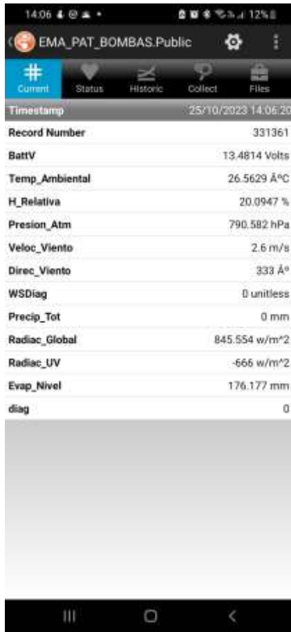
Figura 31. Monitoreo remoto de EMA haciendo uso de un teléfono inteligente.
