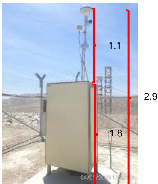
Figura 42. Altura total de instalación para el funcionamiento de equipos TEOM.
