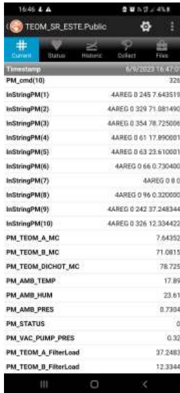
Figura 44. Monitoreo remoto de equipo TEOM haciendo uso de un teléfono inteligente.
