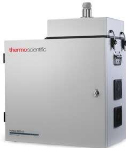
Figura 15. Equipo muestreador de partículas PARTISOL 2025iD (14).
