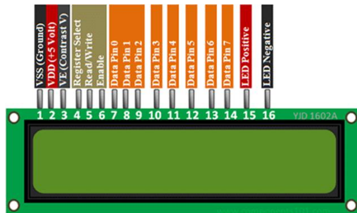
Figura 14. Diagrama de pin display L.C.D. 16 x 2 Tomada de Microcontrollerslab, 2020
