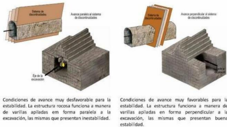
Figura 7 Orientación de la excavación con respecto a los rasgos estructurales (15)
