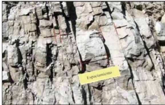
Figura 2. Espaciado de una discontinuidad
