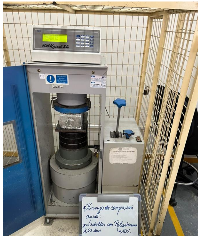
Ensayos de compresión de unidades de albañilería
