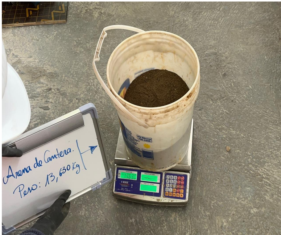
Dosificación de agregado fino de cantera
