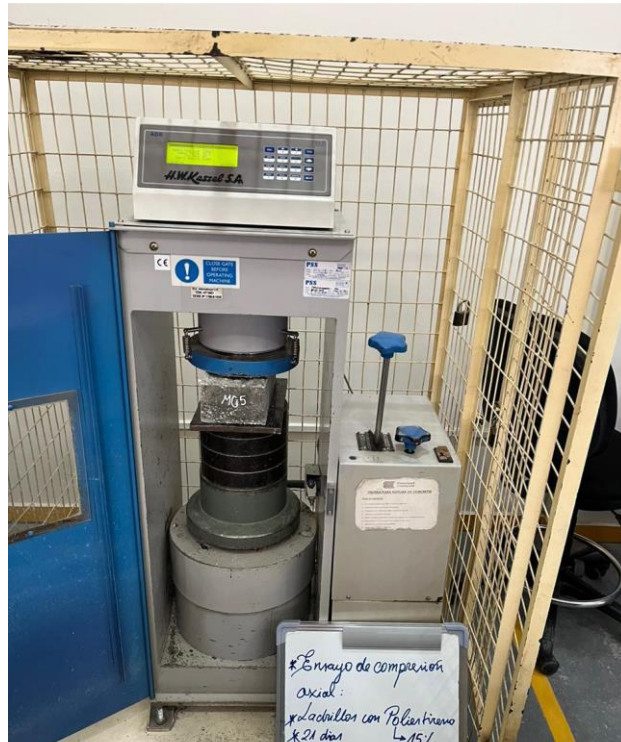
Ensayos de compresión de unidades de albañilería
