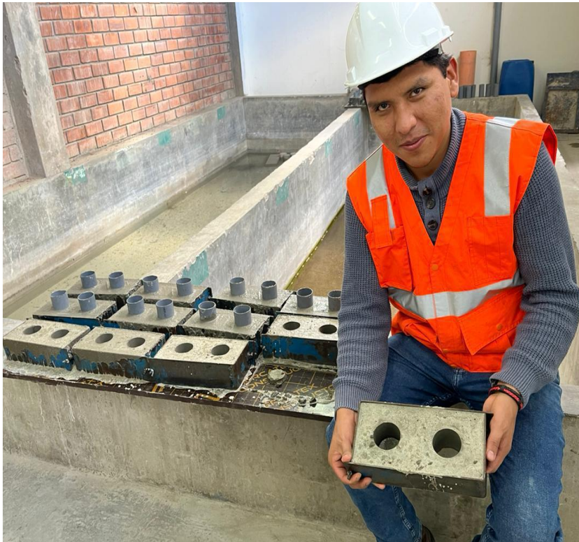
Proceso de desencofrado de las unidades de albañilería
