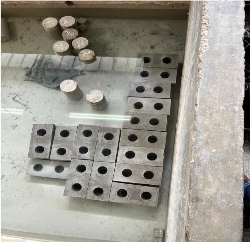
Proceso de curado de ladrillos de concreto
