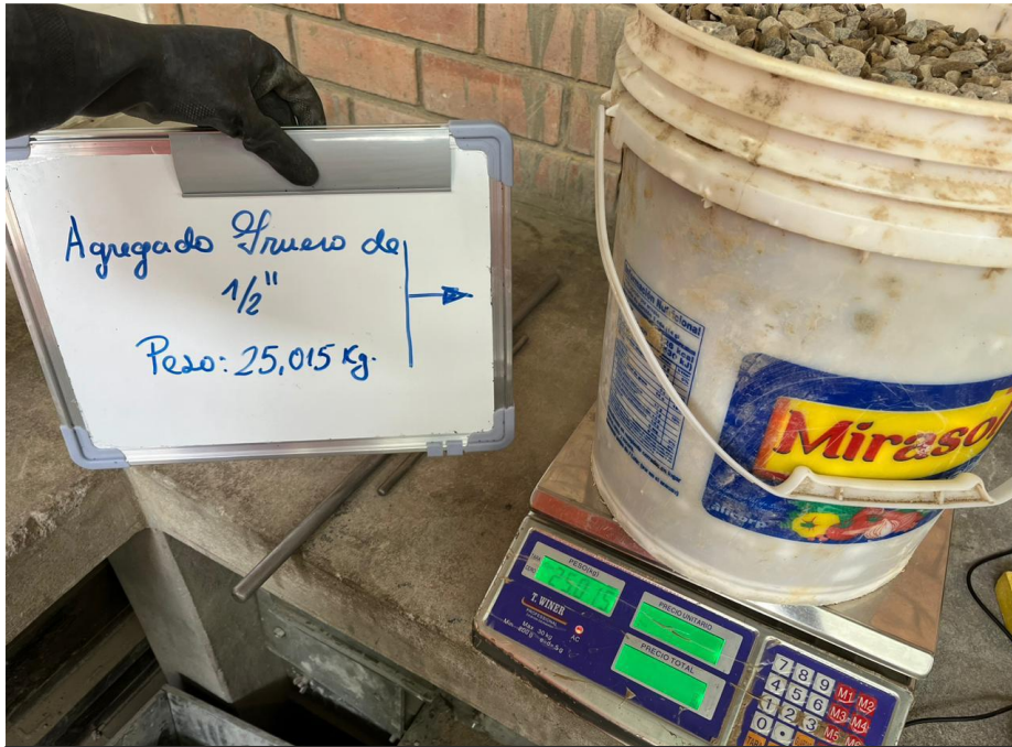
Dosificación de agregado grueso
