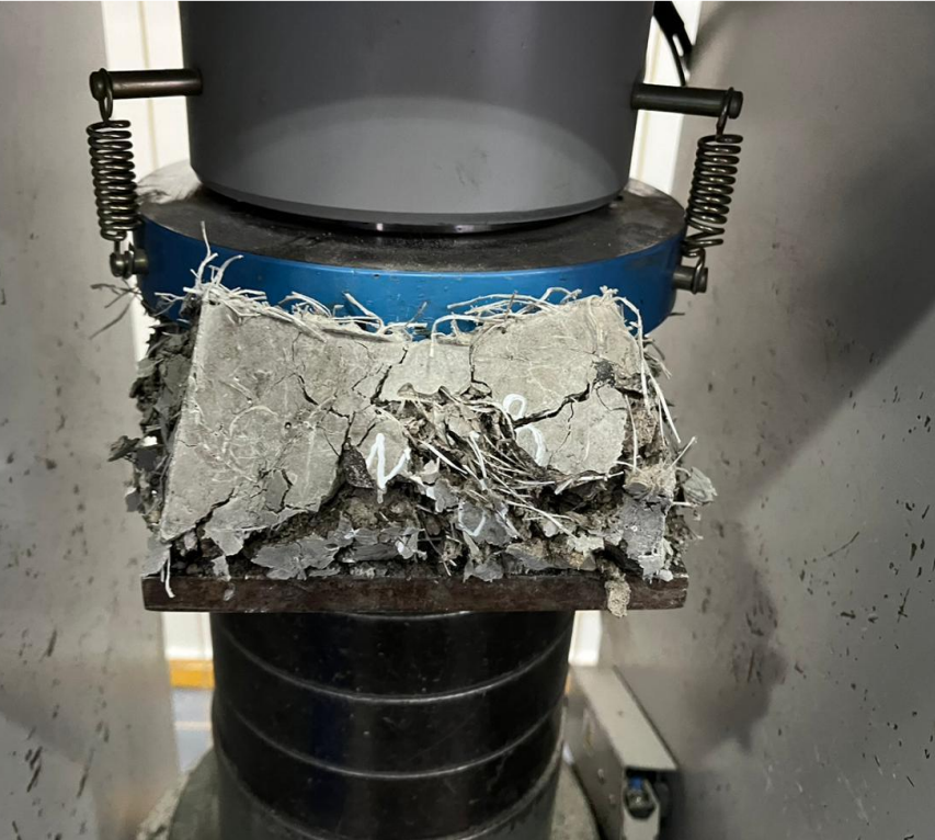
Rotura de las unidades de albañilería
