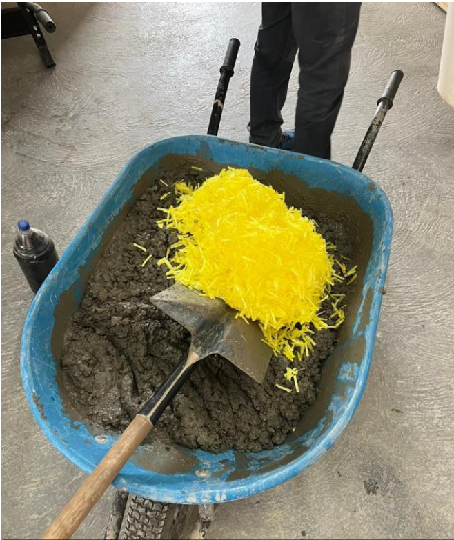
Mezcla de concreto con adición Polímero termoplástico (PET)
