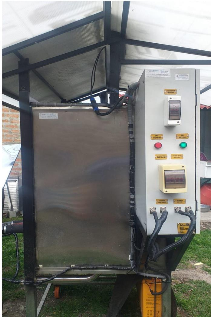
Figura 33. Foto del tablero de control del secador de aguaymanto
