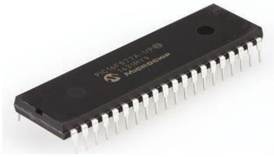
Figura 19. Aspecto exterior del PIC Fuente: Microchip PIC 16f87XA
