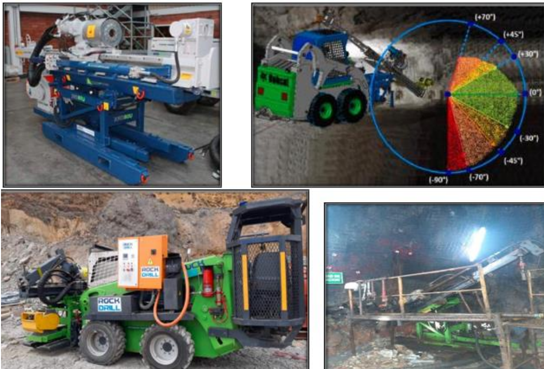
Figura 2. Tipos de máquina para perforación diamantina en interior mina
