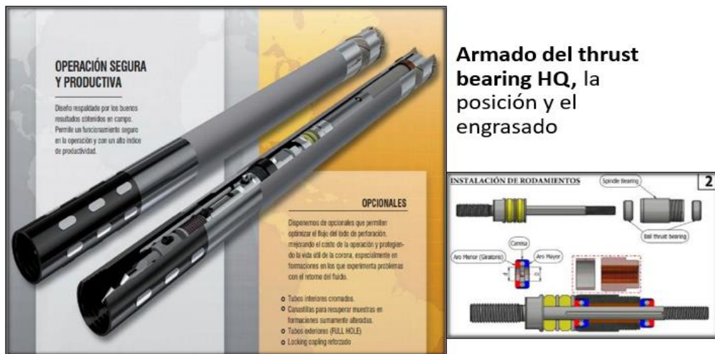
Figura 7. Armado del Thrusbearing HQ
