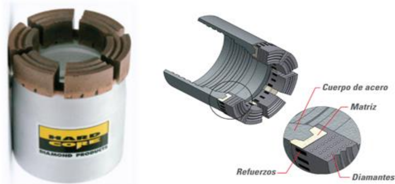
Figura 3. Componentes coronas impregnadas
