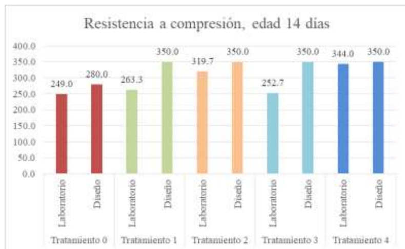
Figura 5. Resistencia a compresión, edad 14 días
