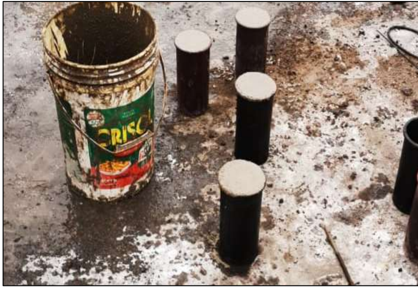
Fotografía 2: Elaboración de probetas de concreto
