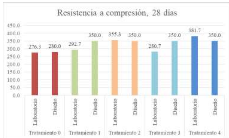
Figura 6. Resistencia a compresión, edad 28 días
