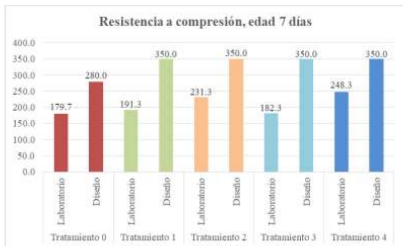
Figura 4. Resistencia a compresión, edad 7 días
