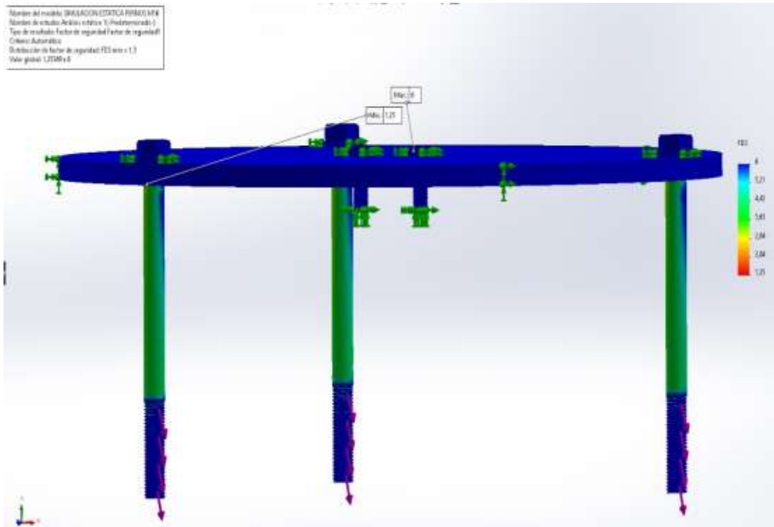
Figura 38. Resultado de factor de seguridad, simulación 3
