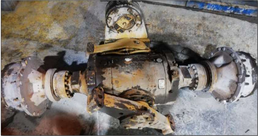
Figura 2. Tren de fuerza posterior de Scoop R1300G Cat Tomada de Caterpillar, 2024
