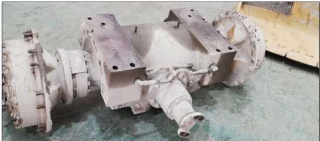
Figura 3. Tren de fuerza delantero de Scoop R1300G Cat Tomada de Caterpillar, 2024
