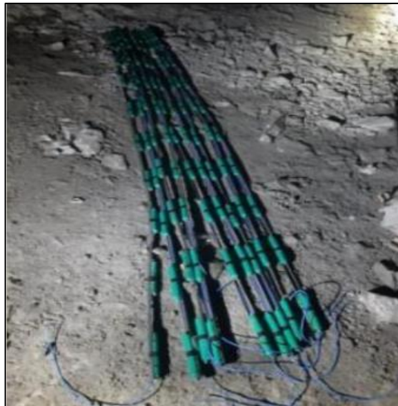
Figura 31. Control del uso de cañas en la voladura de contorno
