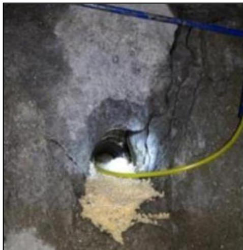
Figura 29. Control del uso de tacos de arcilla
