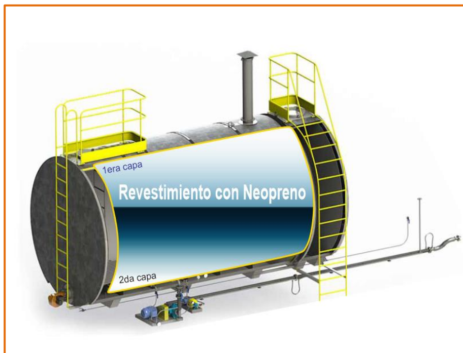
Figura 12. Interior del Tanque Atmosférico con Neopreno
