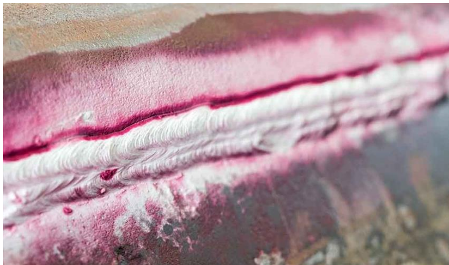
Figura 43. Prueba de líquidos penetrantes
