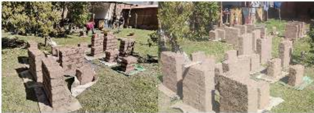
Ilustración 5: Secado de los muretes de adobe.
