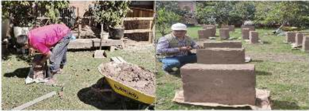
Ilustración 4: Elaboración y secado de muretes de adobe.
