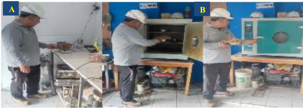
Figura 12. Proceso de humedad relativa. A) Peso de la fibra de eucalipto; B) Secado en horno. Imágenes tomadas del laboratorio ASPHALT
