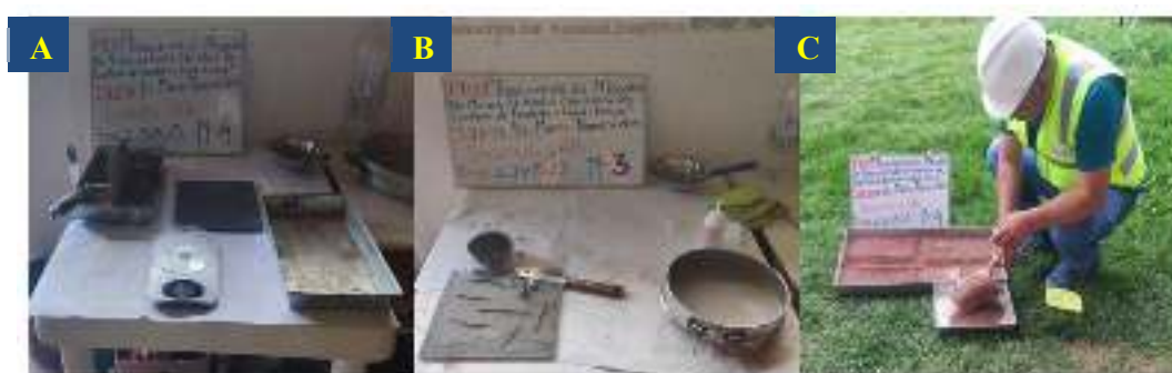
Figura 10. Ensayos físicos del suelo. A) Ensayos de granulometría; B) Ensayos de límites plástico; C) Ensayo de humedad del suelo. Imágenes tomadas del laboratorio Geotecnia V.G.
