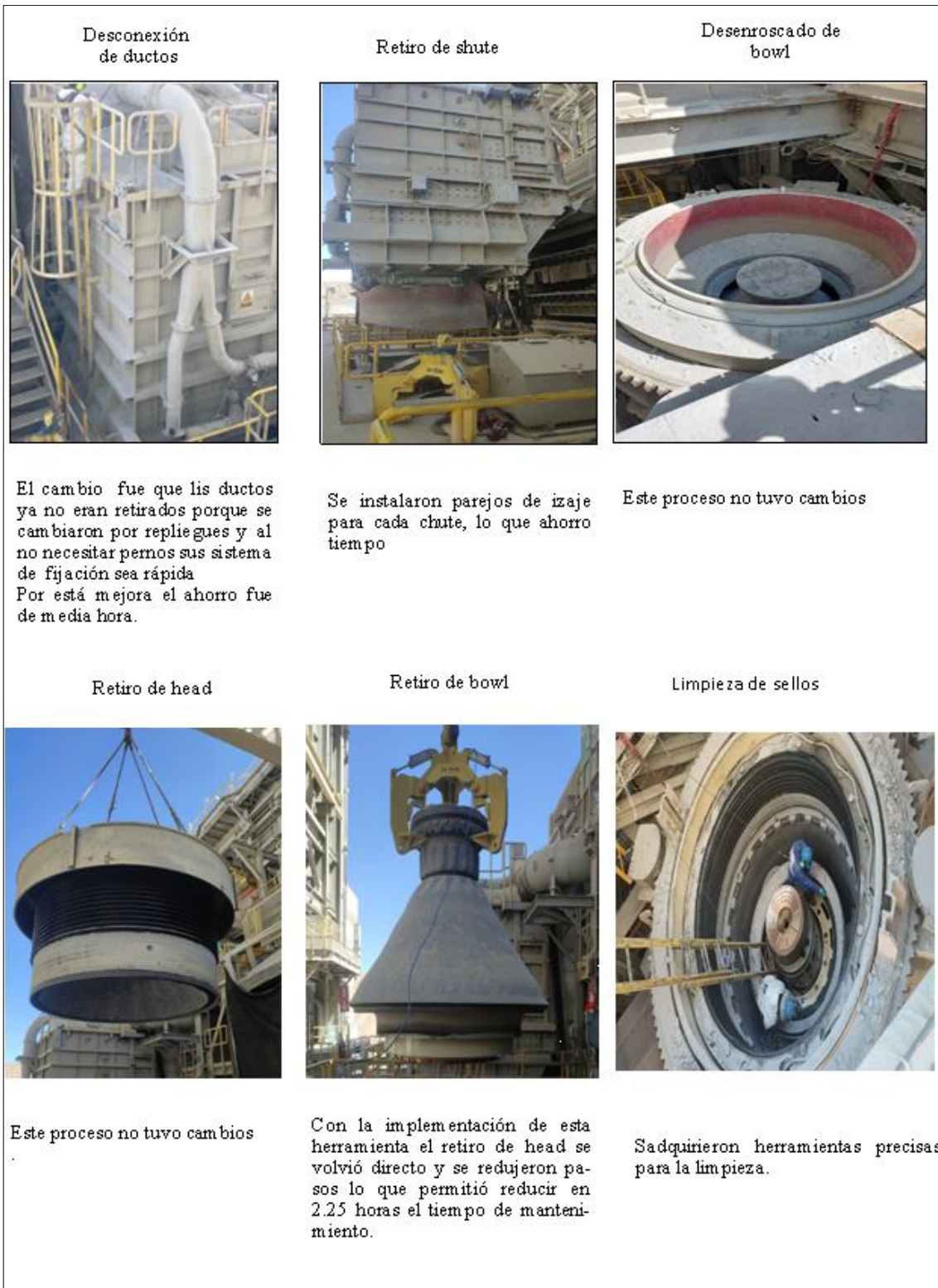
Figura 14. Actividades de mantenimiento. Nota. Reporte de gran minera.
