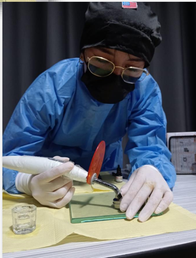
Figura 11. Investigadores realizando el proceso de fotocurado con ayuda de la lámpara LED, para cada una de las muestras de resina trabajadas
