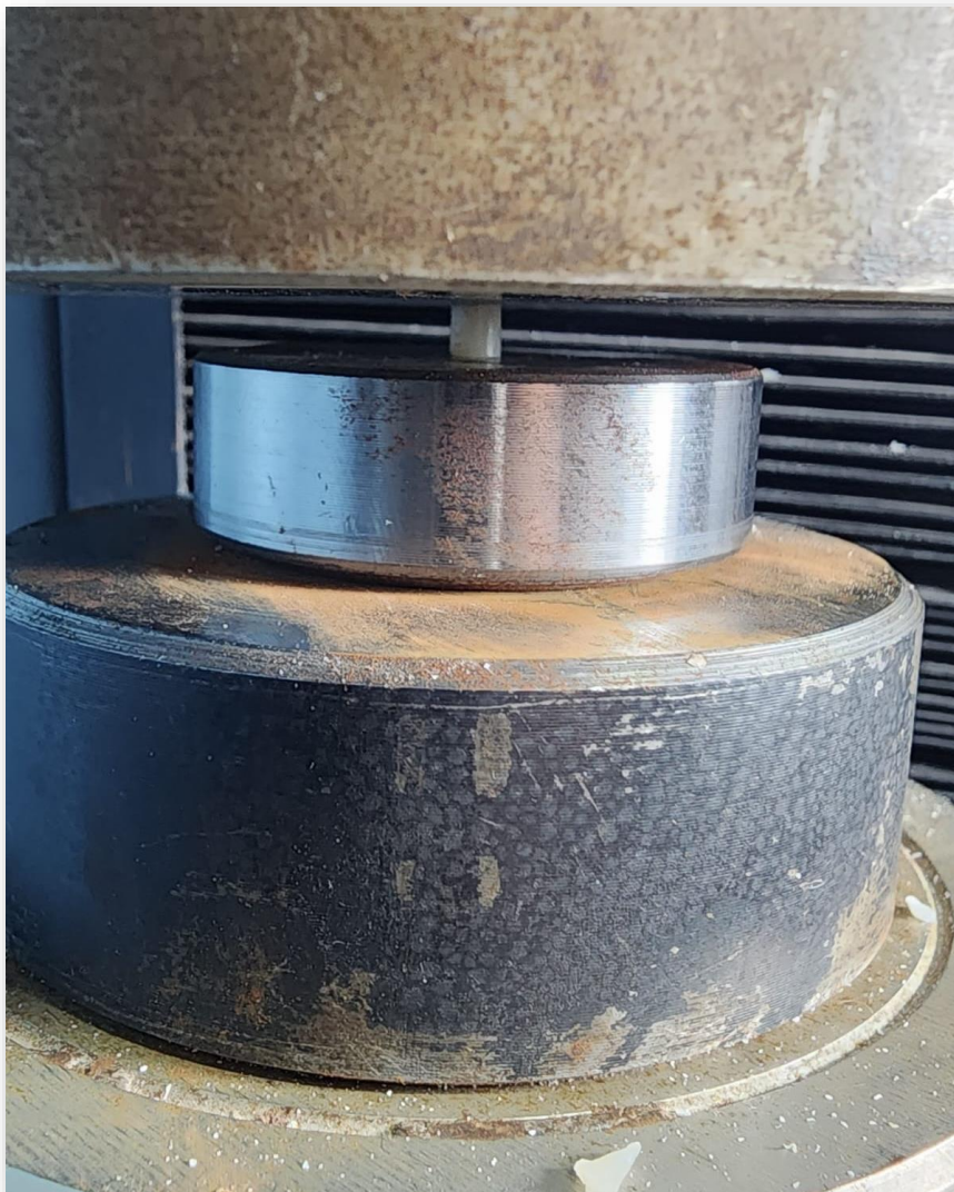
Figura 13. Muestras de resina puestas en la máquina de compresión universal del laboratorio
