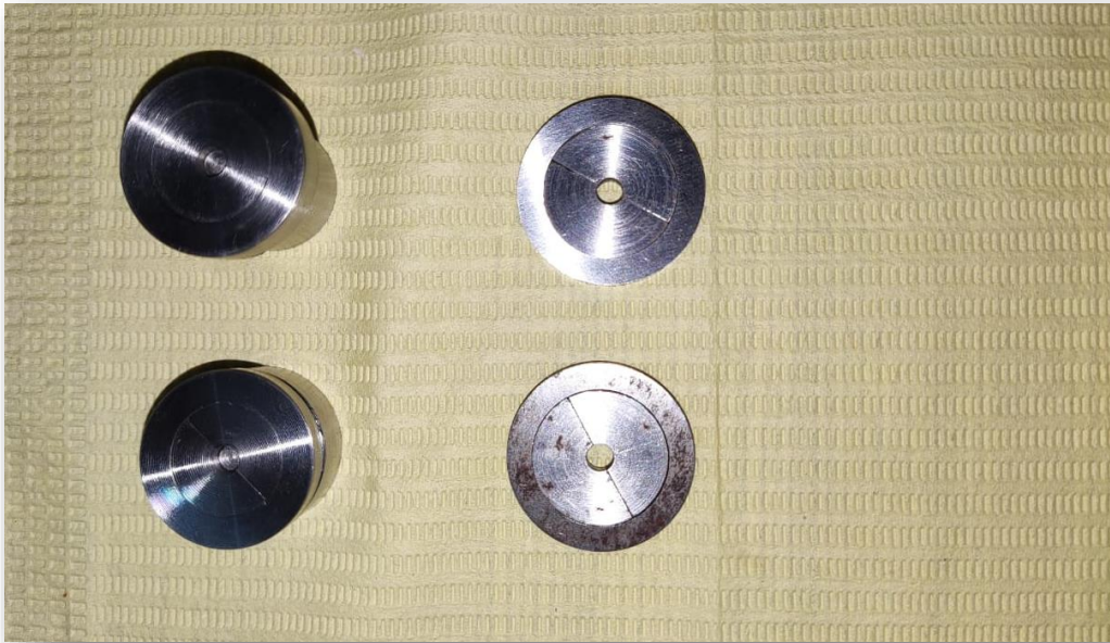
Figura 2. Moldes de 4x2 y 4x4 mm utilizados para elaborar las estructuras cilíndricas de las resinas
