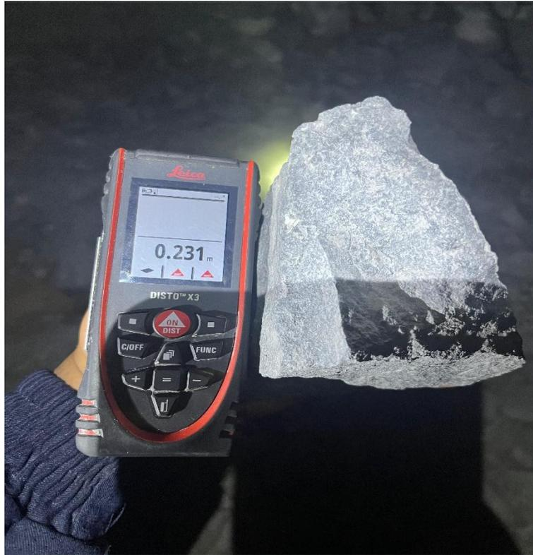
**Figura 11. Material de 23.10 cm., post voladura, Nv 4480**
