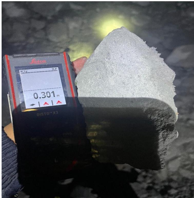
*Figura 11. Material de 30.10 cm., post voladura, Nv 4480*
