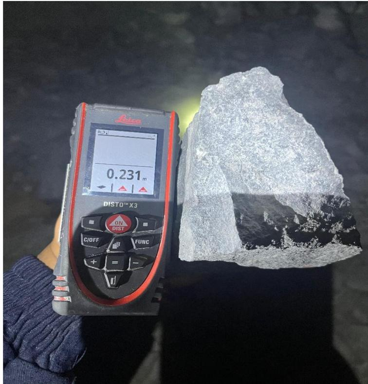
*Figura 10. Material de 23.10 cm., post voladura, Nv 4480*
