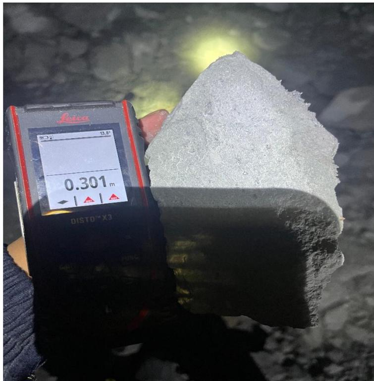
**Figura 12. Material de 30.10 cm., post voladura, Nv 4480**
