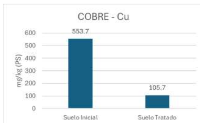
Figura 7. Disminución del contenido de contenido de cobre en el suelo inicial y suelo tratado
