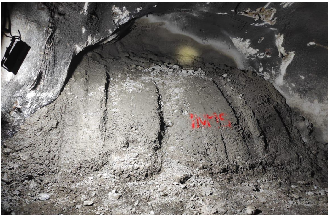
Figura 10. Grado de fragmentación posterior a la voladura - finos
