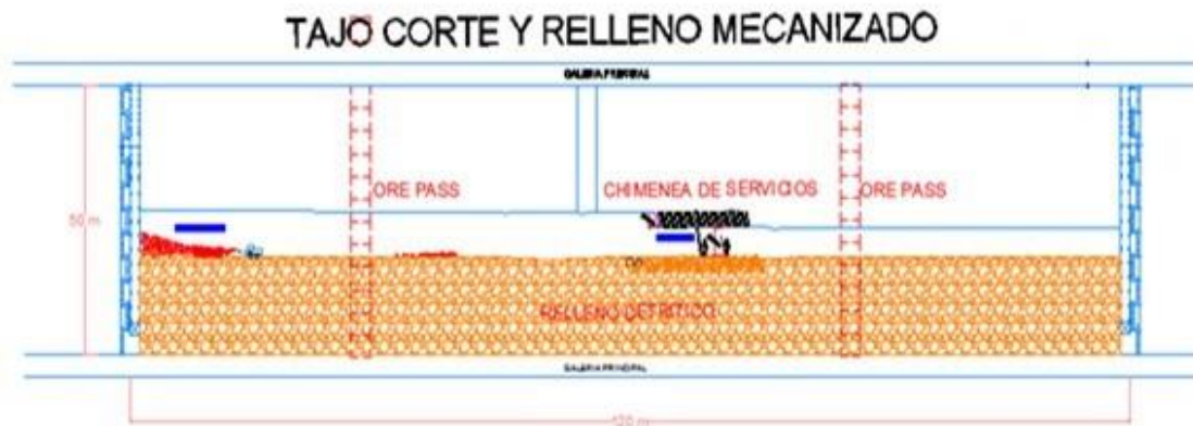
Figura 6. Corte y relleno ascendente en la mina Austria Duvaz Tomada del Área de Planeamiento
