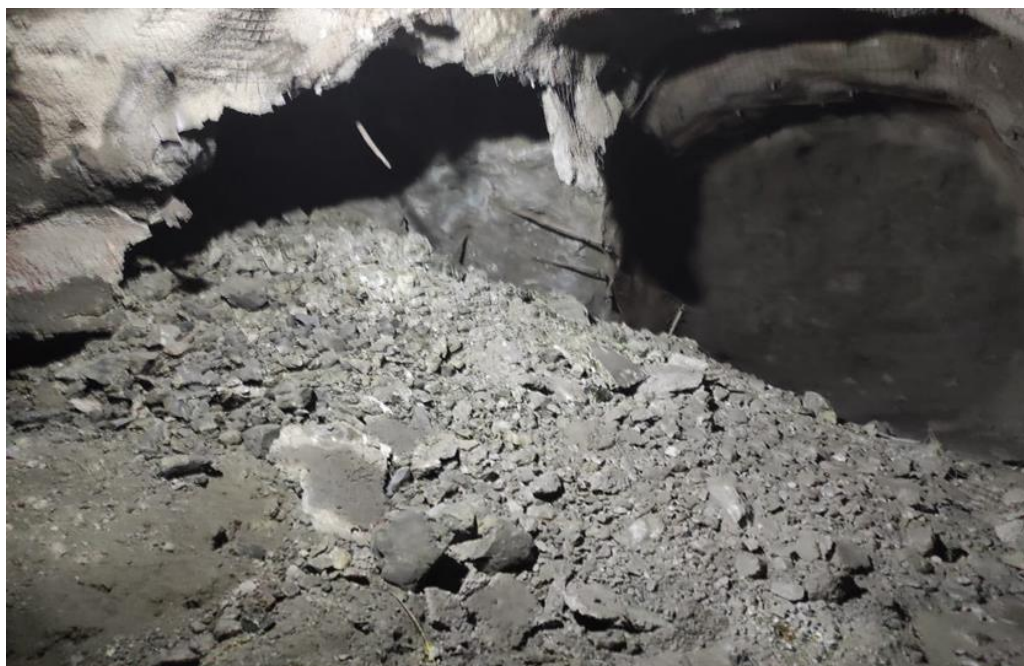
Figura 9. Grado de fragmentación posterior a la voladura – grueso
