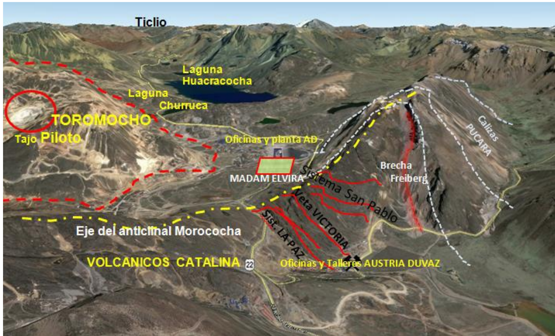
Figura 4. Modelo estructural en la mina Austria Duvaz Tomada del Área Geología
