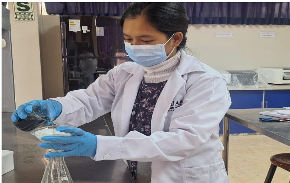
Preparación de la solución cromo hexavalente
