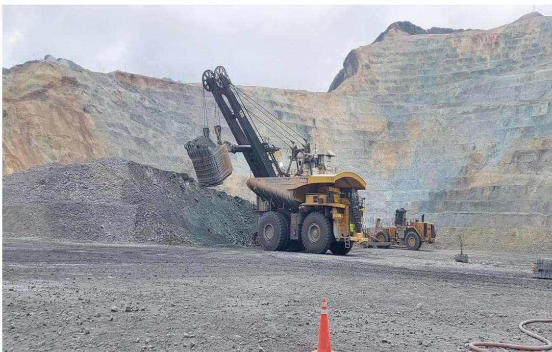
*Figura 4. Proceso de carguío, de palas Cat 7495 en camiones Cat 797F
