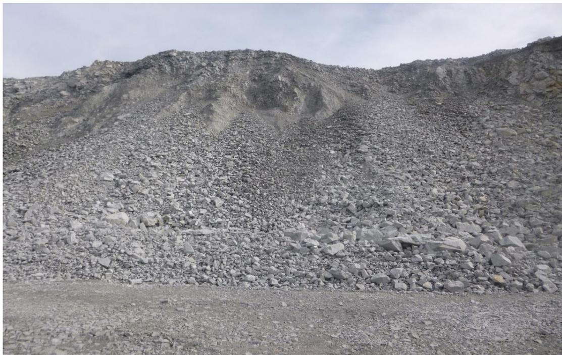
*Figura 25. Material post voladura, zona de trabajo*
