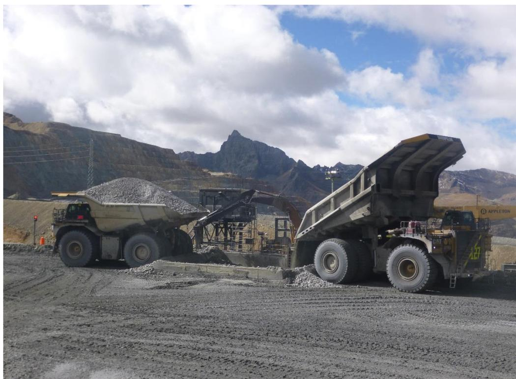
*Figura 10. Equipos de acarreo descargando material en la chancadora*
