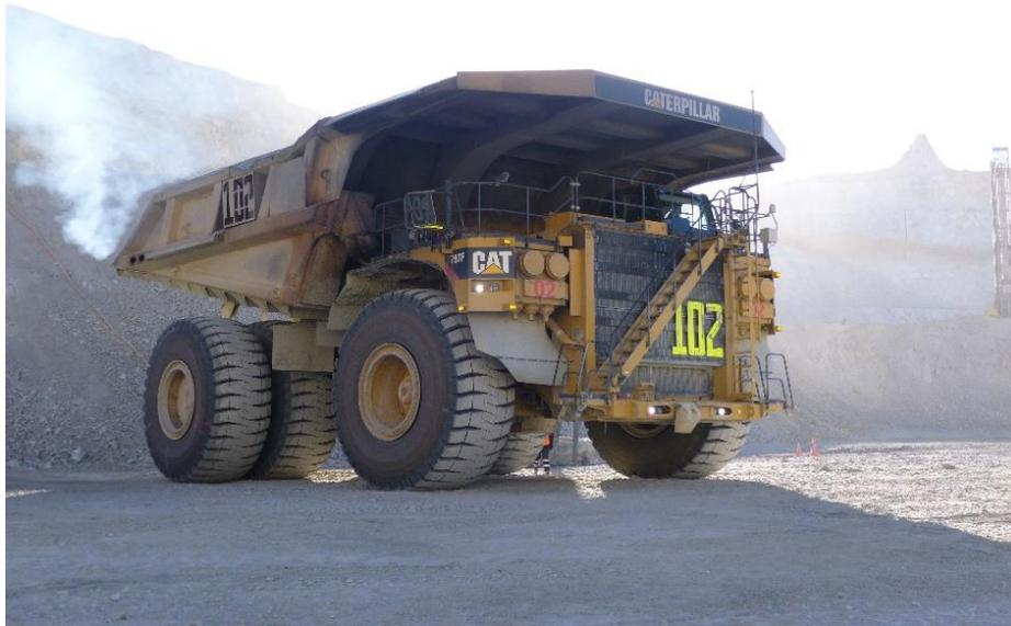
*Figura 5. Equipo de acarreo, camión CAT 797F
