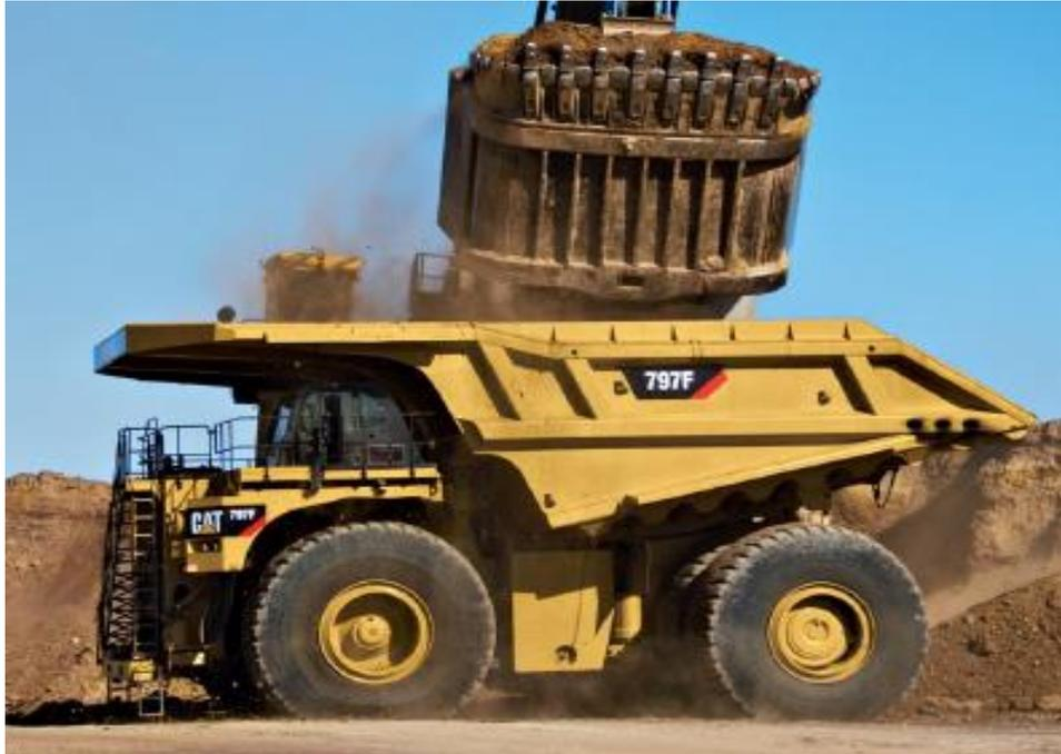
**Figura 11.** Camión minero 797F – Cat. Tomada de “Ficha técnica de Caterpillar” (26).
