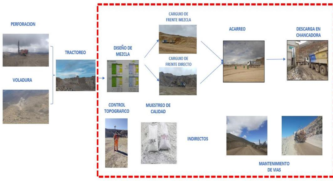
Figura 1. Esquema de secuencia de producción de la compañía minera.
