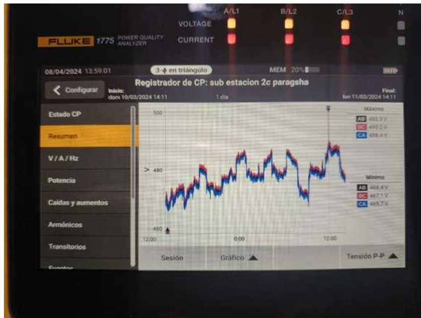
Figura 19. Periodo de medición de tensión 460 V Fuente: Analizador Fluke 1775
