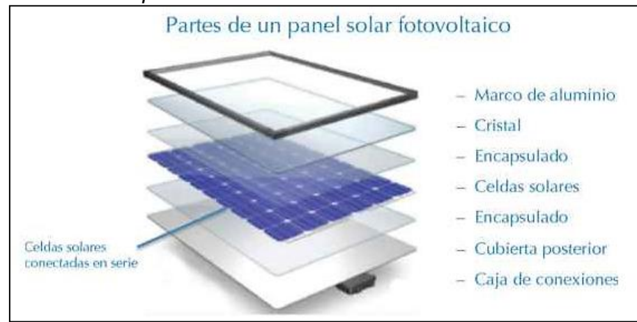
Partes de un panel solar fotovoltaico
