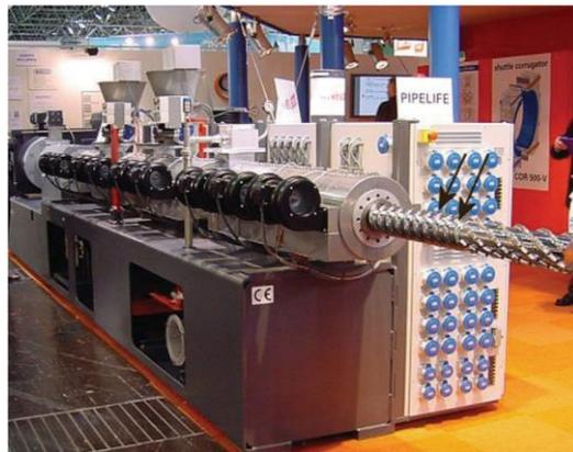
**Figura 11. Boquilla de un extrusor industrial**
