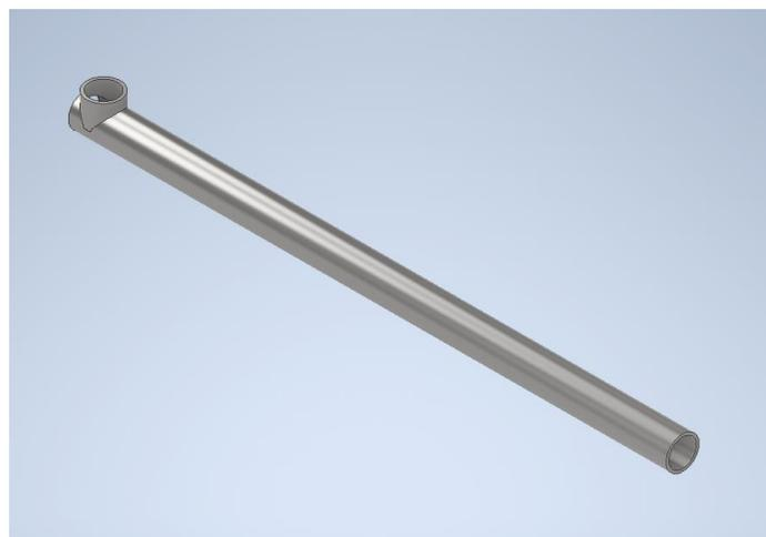
Figura 30. Barril de un extrusor de plástico
