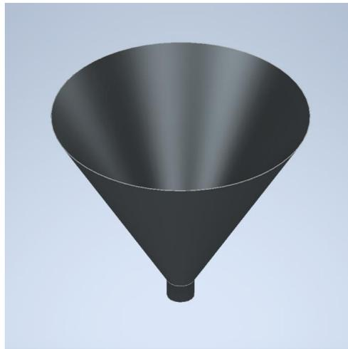
**Figura 29. Tolva del extrusor de plástico**
