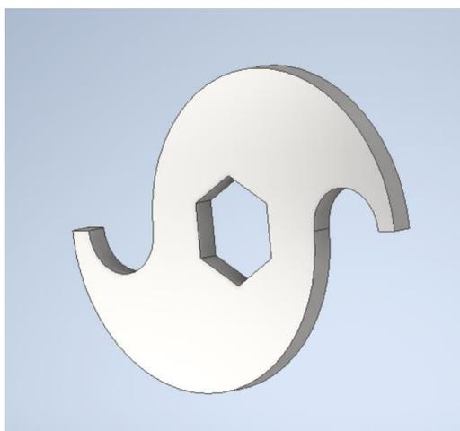
**Figura 22. Cuchilla del triturador**
