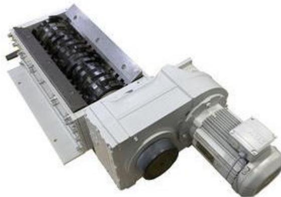
**Figura 16. Triturador de cuchillas**
