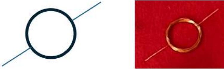
Figura 56. Vista de las bobinas construidas
