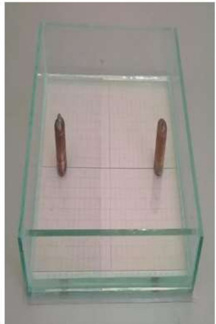
Figura 17. Ubicación de los electrodos en la cubeta.
