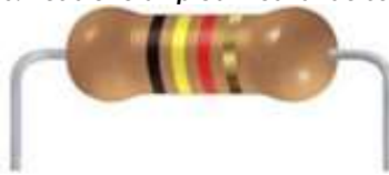
Figura 3. Resistencia típica mostrando su código de colores
