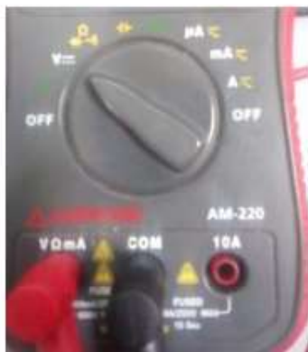
Figura 8. Selector del multímetro ubicado para medir el voltaje en CC
