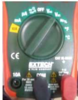
Figura 8. Selector del multímetro ubicado para medir el voltaje en CC
