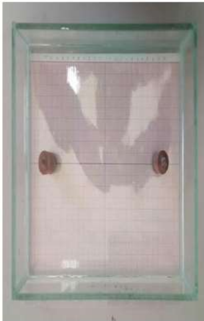
Figura 17. Ubicación de los electrodos en la cubeta.
