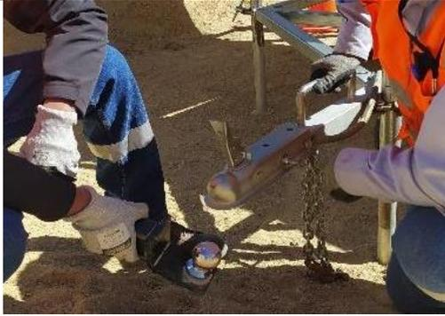
3. Se colocará el PIN de seguridad al gatillo de seguridad de la Mano de Acople, con el objetivo que permanezca en dicha posición.
