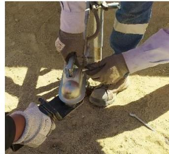
5. Se validará que NO quede espacio vacío entre la mano de Acople y la bola del enganche, lo cual se validará moviendo dicha unión de forma manual.
