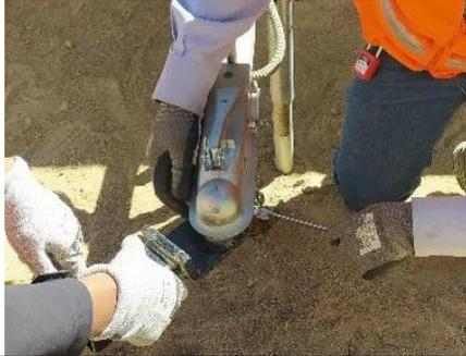
6. Se procede a bajar el precinto de seguridad de la bola del enganche y se colocará el PIN de seguridad para el asegurar el correcto enganche.
