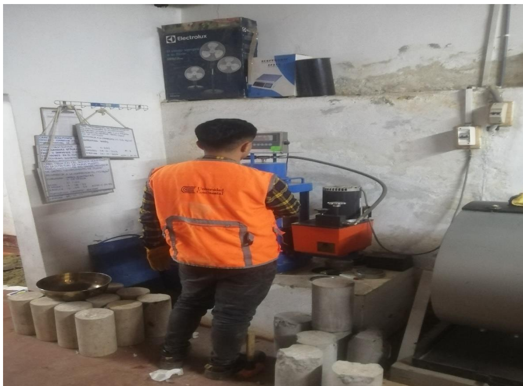
19. Ensayo de Marshall de briquetas de mezcla asfáltica semi caliente modificada al incorporar el material reciclado, según la norma MTC E 504
