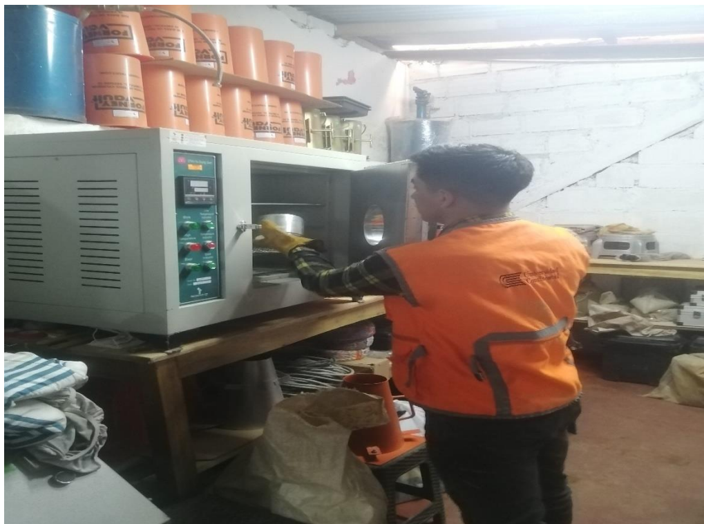
11. Control de temperatura para aplicación del aditivo Zycotherm, según la norma MTC E 504
