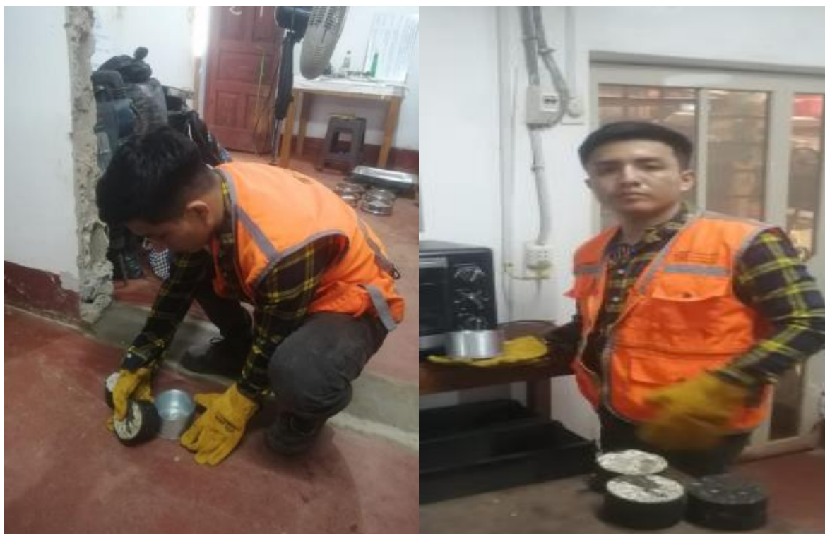
12. Briquetas resultantes al adicionar Zycotherm, según la norma MTC E 504
