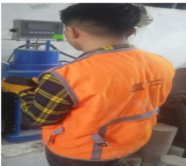
Figura 18. Ensayo de resistencia en aparato de Marshall, según la norma MTC E 504
