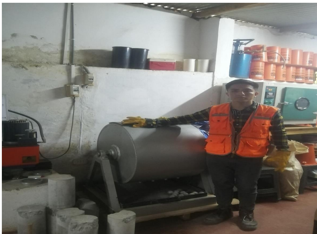
20. Ensayo de Cántabro en seco de briquetas de mezcla asfáltica semi caliente modificada al incorporar el material reciclado según la norma MTC E 515
