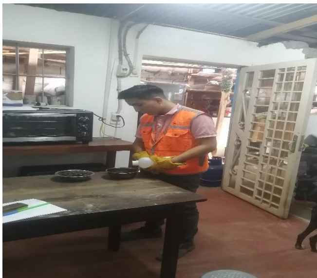
Figura 13. Ensayo de Rice de mezclas asfálticas, según la norma MTC E 508
