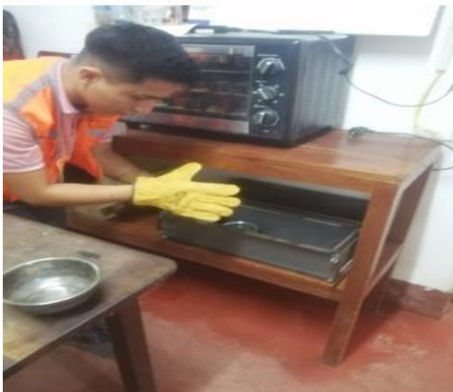
Figura 17. Briquetas colocadas en baño María, según la norma MTC E 508
