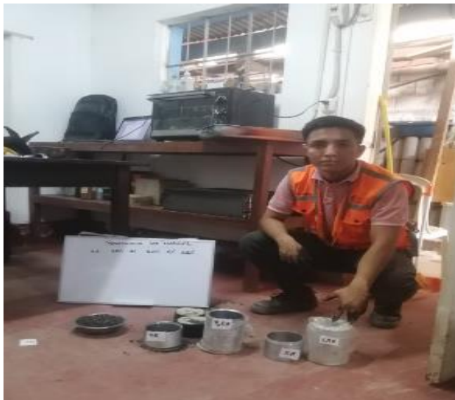
Figura 16. Briquetas resultantes a diferentes porcentajes de cemento asfáltico, según la norma MTC E 508
