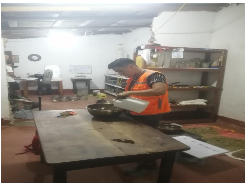
10. Aditivo Zycotherm para la elaboración de mezcla asfáltica semi caliente, según la norma MTC E 515
