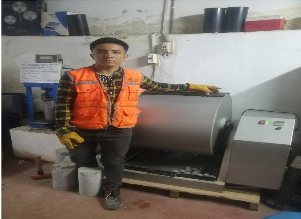
15. Ensayo de Cántabro en seco de briquetas de mezcla asfáltica semi caliente al adicionar Zycotherm, según la norma MTC E 515
