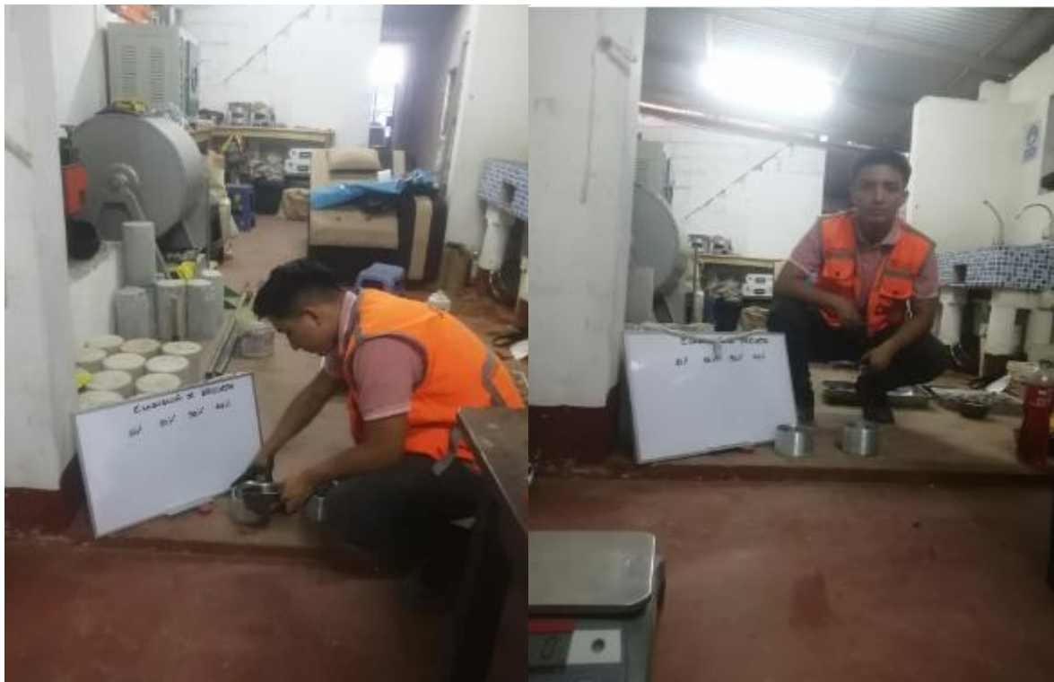
7. Elaboración de briquetas para el ensayo de peso específico, según la norma MTC E 508
