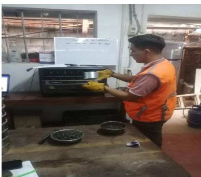
Figura 14. Proceso de elaboración de briquetas de mezcla asfáltica caliente, según la norma MTC E 504
