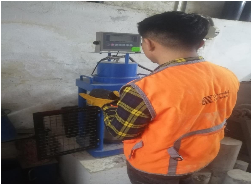
14. Ensayo de Marshall de briquetas de mezcla asfáltica semi caliente al adicionar Zycotherm según la norma MTC E 504
