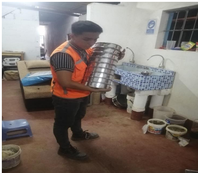
Figura 31. Ensayo de granulometría de material reciclado, según la norma MTC E 503
