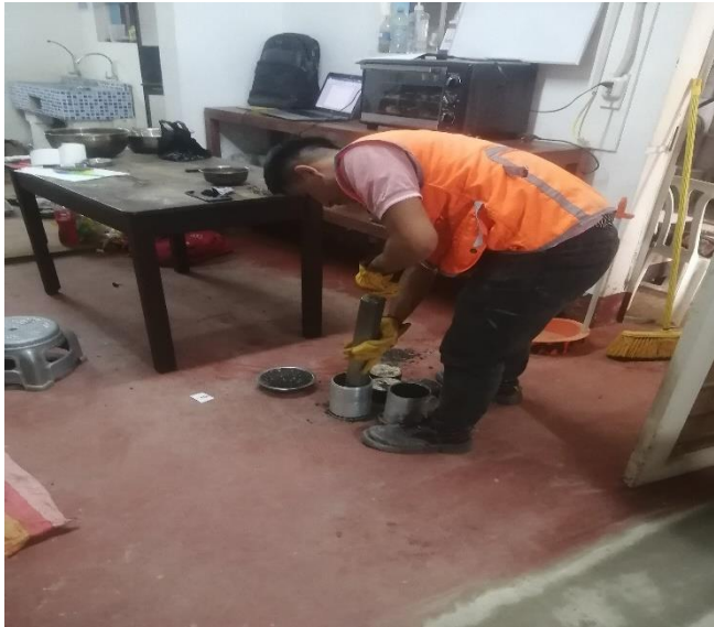
Figura 15. Compactación de briquetas diseñadas, según la norma MTC E 504
