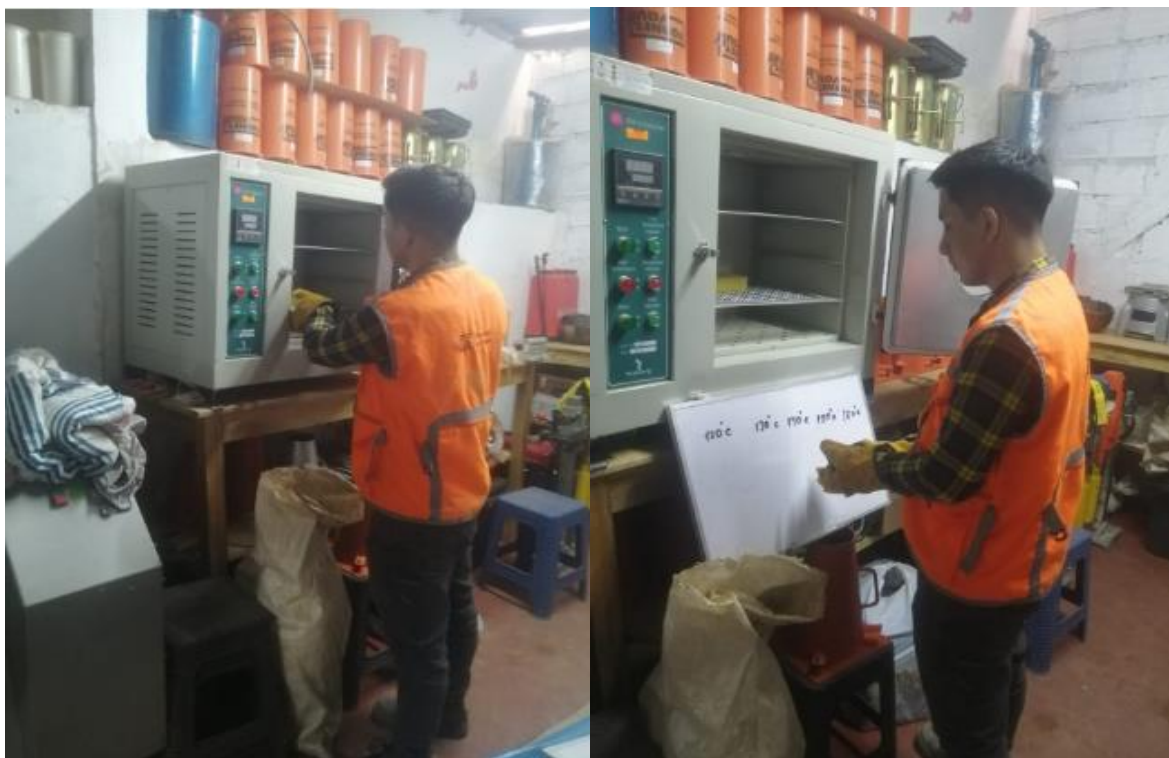
17. Control de temperatura para incorporación del material reciclado en distintos porcentajes
