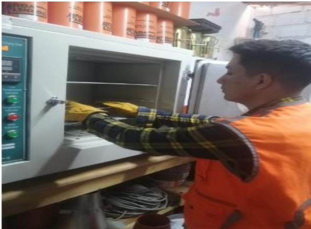
13. Ensayo de peso específico de briquetas de mezcla asfáltica semi caliente al adicionar Zycotherm, según la norma MTC E 504
