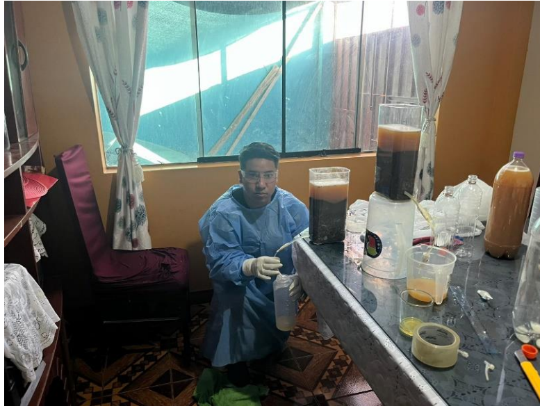
Figura 21 Tratamiento de filtración 1 primera parte de filtrado, ingreso de agua residual de Car Wash, y salida al tratamiento 2 se analizo pH, C.E, SD y turbidez
