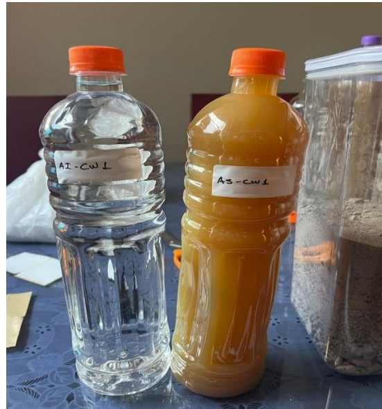
Figura 18 Muestras al ingreso y salida de Car Wash o lavado de autos, se distingue los colores a simple vista del agua potable de ingreso y el agua residual del lavado de autos
