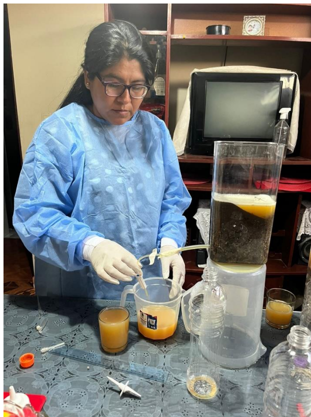
Figura 22 Tratamiento de filtración 2, salida final del tratamiento al agua residual de Car Wash, para evaluar y analizar el pH, C.E., SD y Turbidez
