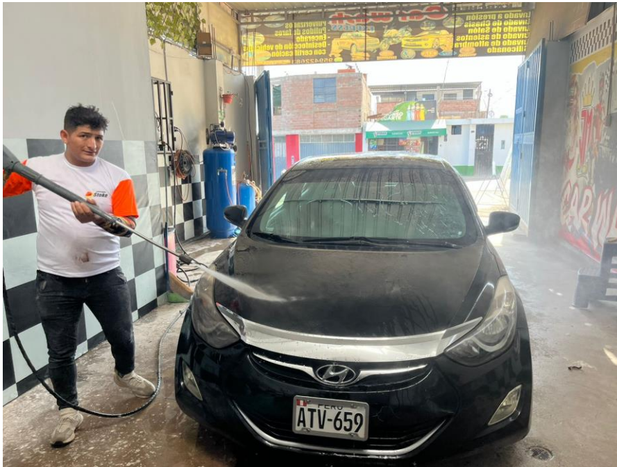
Figura 15 Lavado de auto en Car Wash de Moquegua, se realiza con manguera a presión agua de consumo humano y a alta presión previo limpieza en seco
