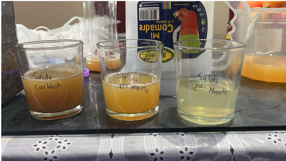
Figura 23 Resultados obtenidos Salida Car Wash, salida tratamiento 1 y tratamiento 2, se puede observar a simple vista la diferencia de colores, es decir la turbidez que se ha ido perdiendo al paso por los filtros de arena, grava y piedra caliza
