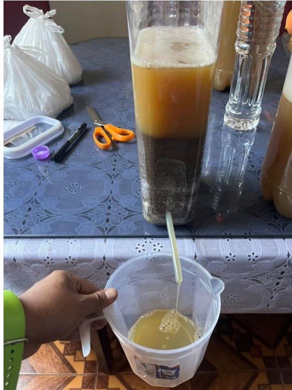
Figura 20 Inicio de la filtración por arenas, grava y piedra caliza, el paso a través de la maqueta es lento para que el tiempo necesario para una mejor filtración
