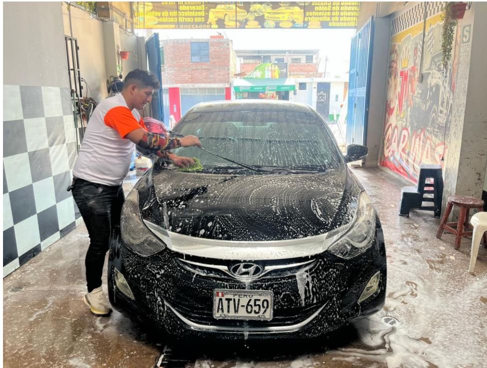
Figura 16 Lavado con detergente al auto, detergente previamente preparado en un barril de 200 litros se presiona fuertemente al auto para remover grasas y polvo
