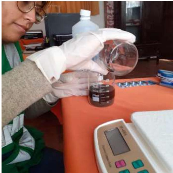
*Figura 56. Preparación del medio para medir pH*
