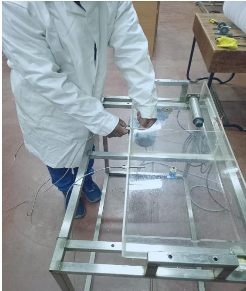
Fotografía que muestra la instalación de los sensores de temperatura en cada celda del recipiente de acrílico
