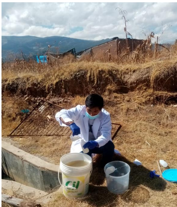
Fotografía en el que se observa el trasvase de muestra de agua en un recipiente de polietileno, que fue enviado al laboratorio de análisis.
