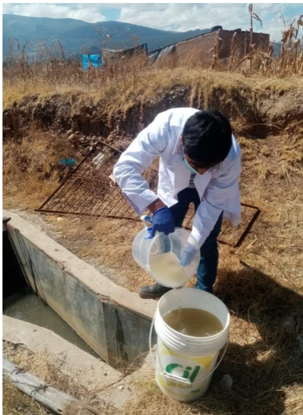
Fotografía que muestra el trasvase al recipiente de 20 L con la ayuda de otro recipiente para cubrir el volumen requerido en los experimentos
