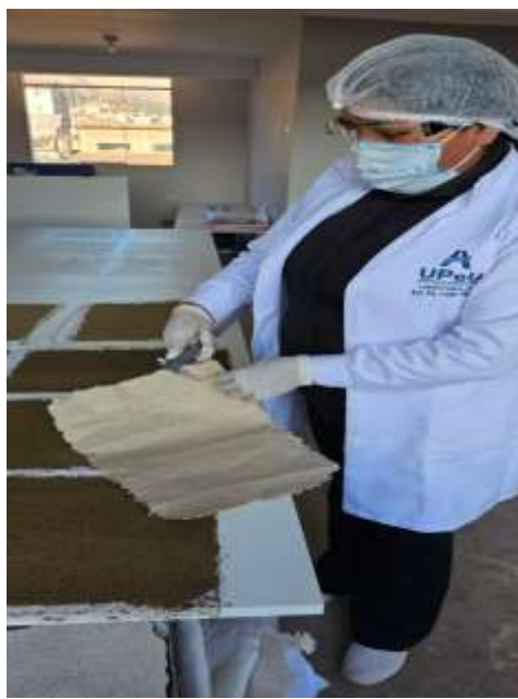
Figura 32. Toma de medidas del espesor de papel artesanal
