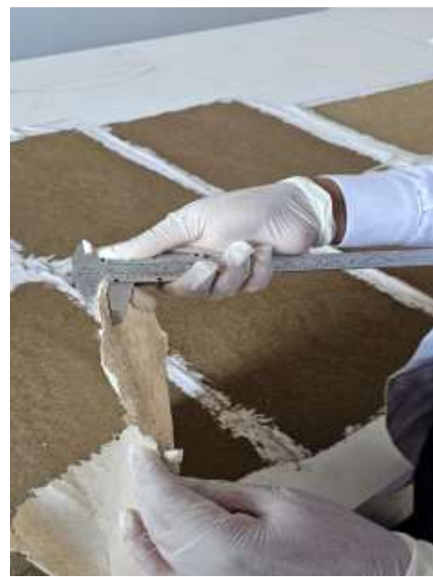
Figura 32. Toma de medidas del espesor de papel artesanal
