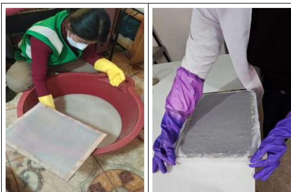
Figura 30. Proceso de modelado, que consiste en agitar tanto en dirección horizontal como vertical hasta conseguir una lámina uniforme
