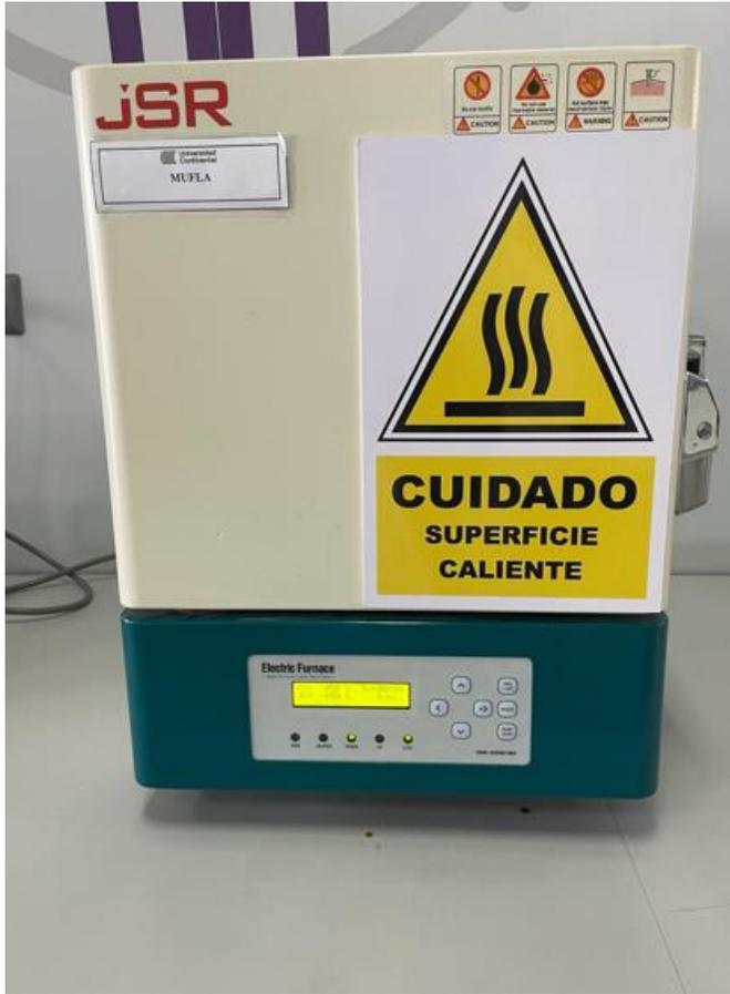
3. Pasadas las 24h retirar la muestra de suelo con ayuda del guante termino y las pinzas, se pesó el crisol con la muestra de suelo 32.5g (pf)
