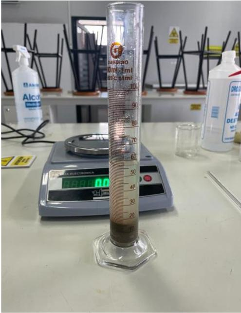
4. Posterior a ello se realizó el cálculo para determinar el volumen desplazado que se obtiene en base al peso del agua desplazado que se realiza con la siguiente formula:
