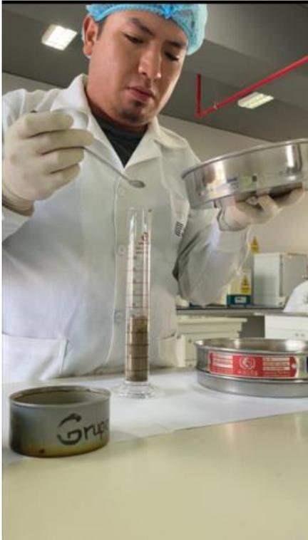
5. Dejar caer la probeta sobre el tampón de jebe 10 veces desde una altura de 5 cm. Anotar el volumen final de la muestra en la línea (2).
