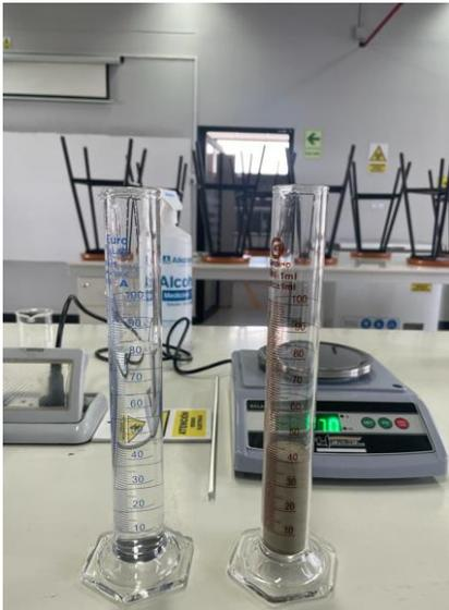
3. Agregar la muestra de suelo a la probeta con el agua y pesar; 241.3g (p3)
