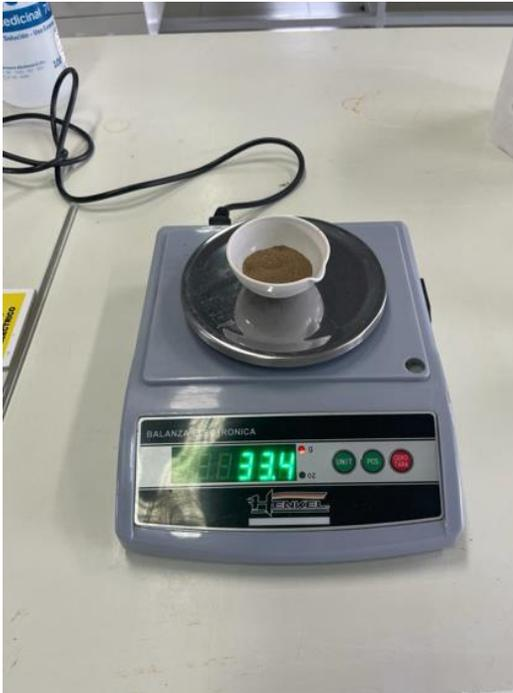
2. Se agregaron los 10g de muestra de suelo en el crisol (pi), luego se programó la mufla a 450° por 24h y finalmente se introduce el crisol a la mufla por 24h.
