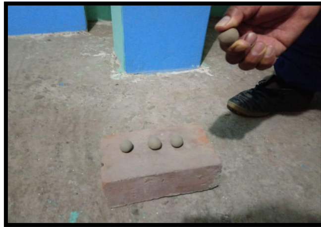
Figura 15 Prueba de la Resistencia Seca - Luego de 48 Horas
