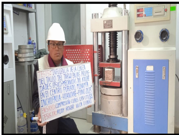
Figura 39 Ensayo de Compresión de Cubos
