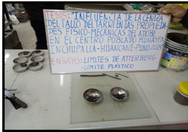
Figura 21 Ensayo de Límites de Atterberg (Límite Plástico)
