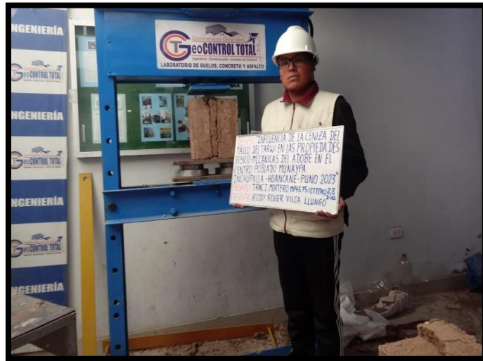
Figura 42 Ensayo del Mortero a Tracción Indirecta
