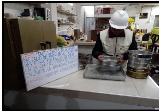
Figura 19 Ensayo de Análisis Granulométrico (Tamizado)
