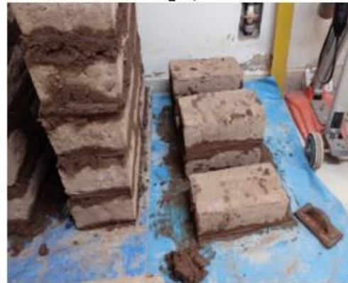
3. Probetas de dos adobes (MP+0.75 % CTT)
