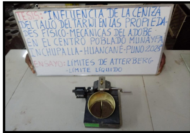
Figura 20 Ensayo de Límites de Atterberg (Límite Líquido)
