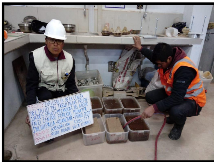
Figura 38 Ensayo de Absorción de los Adobes
