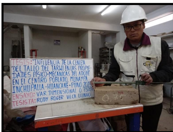
Figura 36 Ensayo de Variación Dimensional de los Adobes
