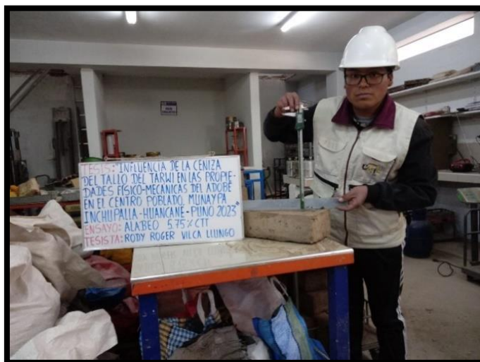
Figura 37 Ensayo de Alabeo de los Adobes
