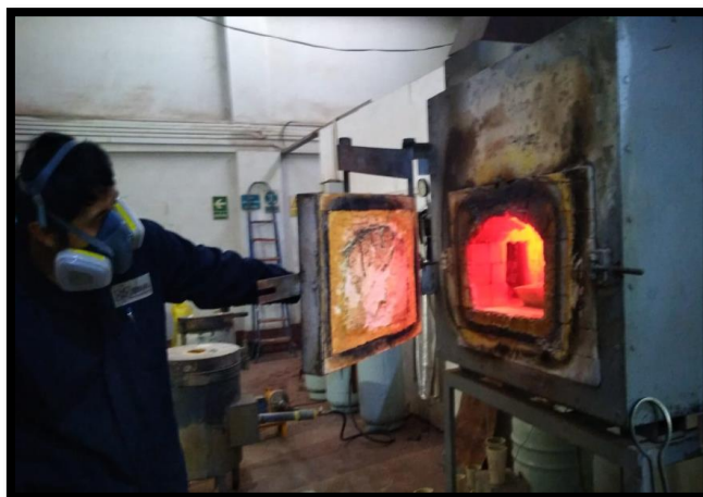
Figura 24 Calcinación de la Ceniza del Tallo del Tarwi en el Laboratorio RHLAB S.A.C.
