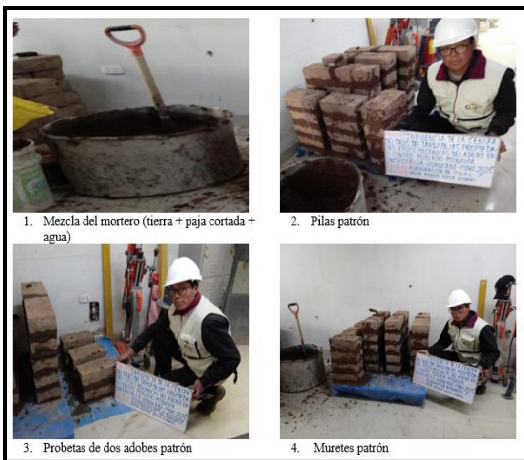
Figura 31 Proceso de Elaboración de las de Pilas, Probetas de Dos Adobes y Muretes Patrón
