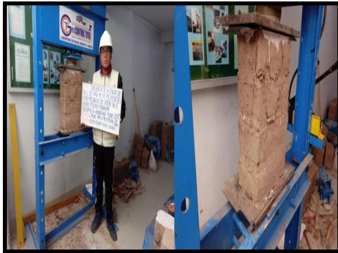
Figura 41 Ensayo de Compresión de Pilas
