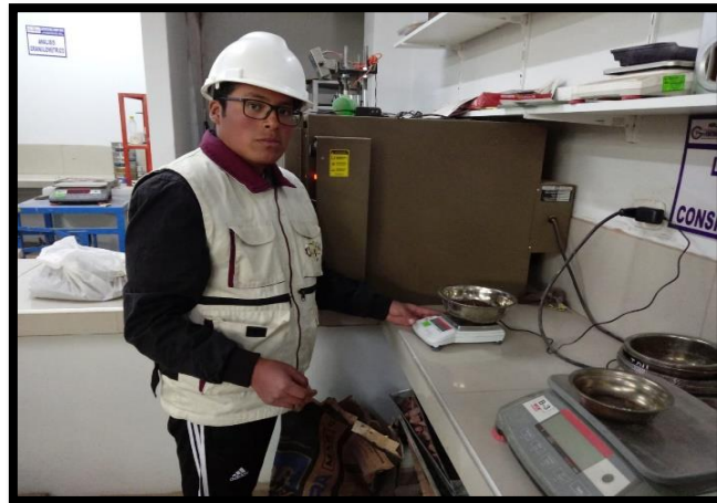
Figura 17 Ensayo de Contenido de Humedad (Pesado de muestra)
