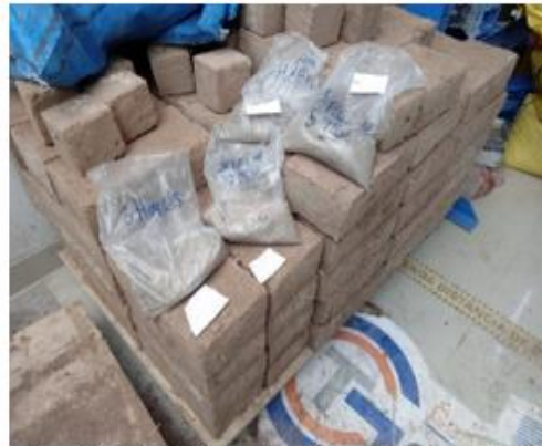
1. Mezcla del mortero (tierra + paja cortada + 0.75 % CTT + agua)
