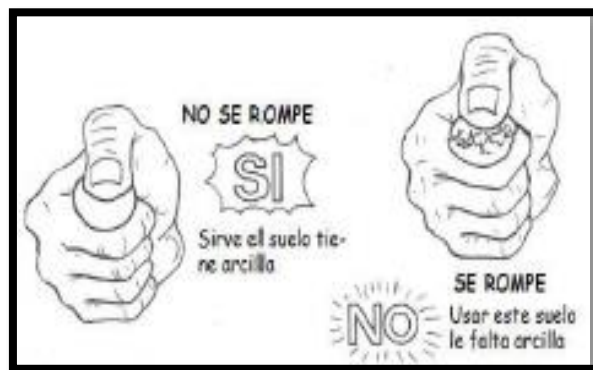
Figura 2 Prueba de la Resistencia Seca
