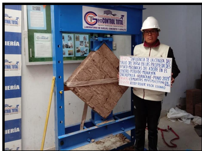
Figura 43 Ensayo de Compresión Diagonal del Murete
