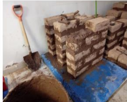
4. Muretes (MP+0.75 % CTT)
