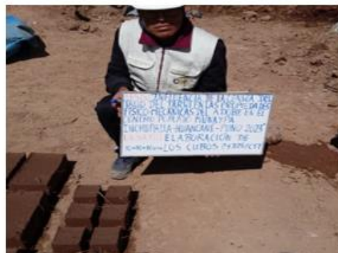
4. Moldeo y desmoldado de los cubos de 10*10*10 cm
