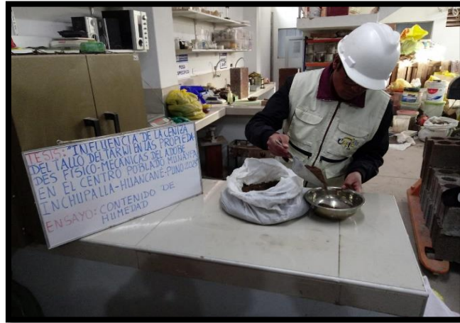
Figura 16 Ensayo de Contenido de Humedad
