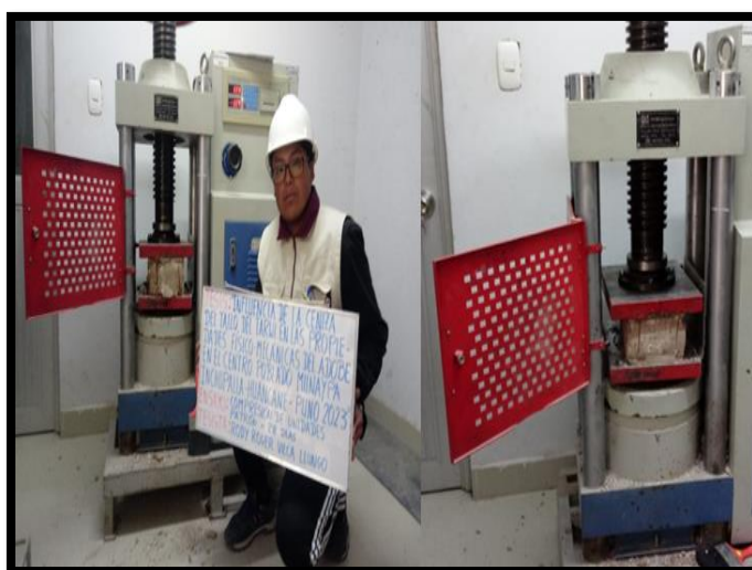
Figura 40 Ensayo de Compresión de Unidades
