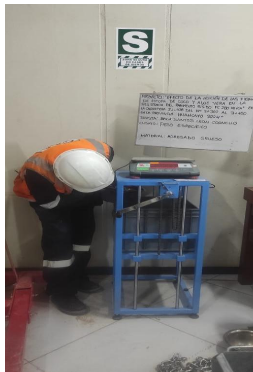
Figura 10. Ensayo de peso específico - agregado grueso.
