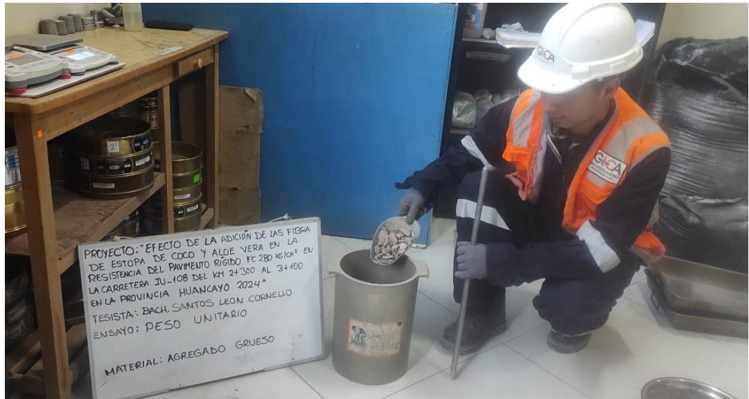
Figura 9. Ensayo de peso unitario al agregado grueso.
