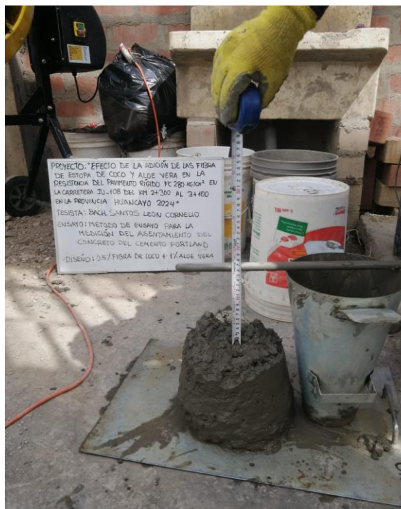
Figura 59. Panel Fotográfico- Ensayo de Slump.
