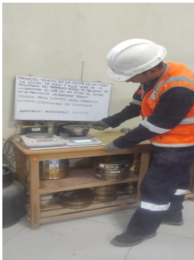
Figura 8. Ensayo de humedad al agregado grueso.
