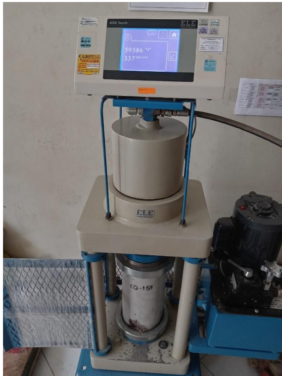
Figura 72. Ensayo de resistencia a la compresión.
