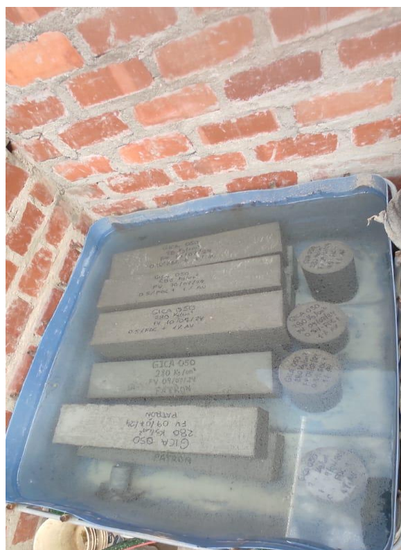
Figura 61. Panel fotográfico-Curado de vigas y probetas
