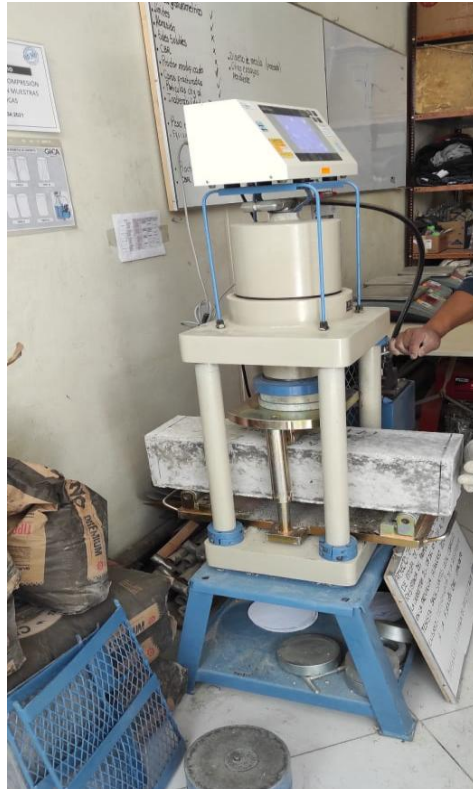
Figura 74. Ensayo de resistencia a la flexión.
