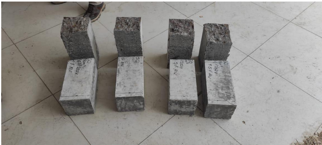
Figura 75. Ensayo de Resistencia la Flexión.
