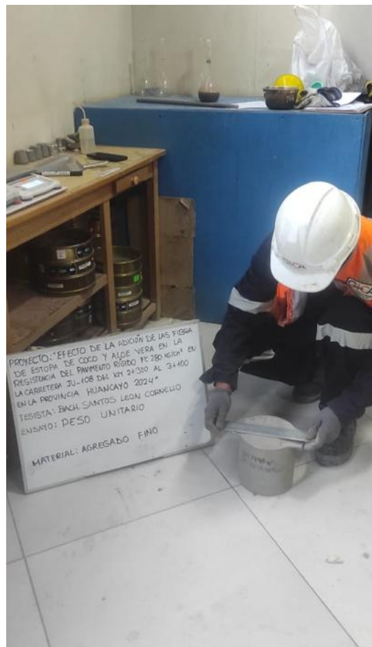
Figura 5. Ensayo de peso unitario - agregado fino.
