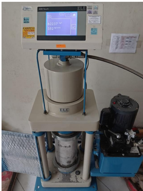
Figura 73. Ensayo de resistencia a la compresión.
