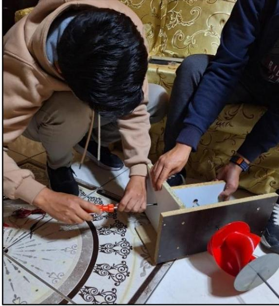
**Anexo 20. Ensamblado e instalación de aletas a la base de melamina.**
