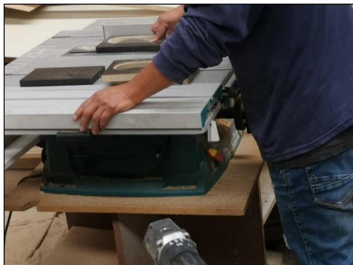
**Anexo 13. Armado de los cortes de melamina para soporte de aletas.**
