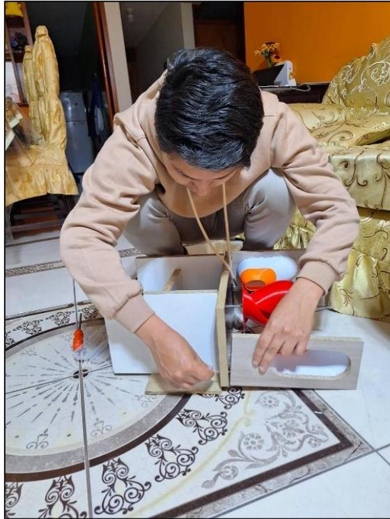
**Anexo 22. Ajuste de la segunda base superior al prototipo de la turbina.**
