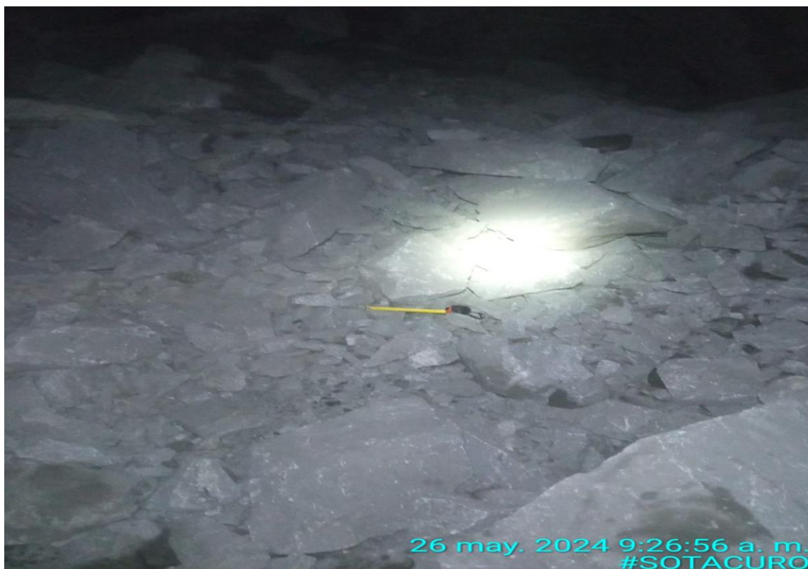
Figura 16. Granulometría post voladura, Cx470 Nv1710, escenario mejorado, dique
