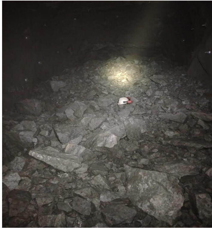
Figura 14. Granulometría posvoladura, Cx448 Nv1740, escenario inicial, dique
