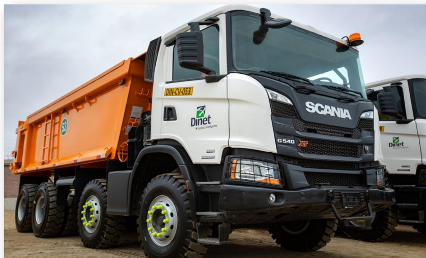
Figura 7. Equipo de acarreo, volquete Scania 8x4 de 42 toneladas Tomada del Departamento de Planeamiento
