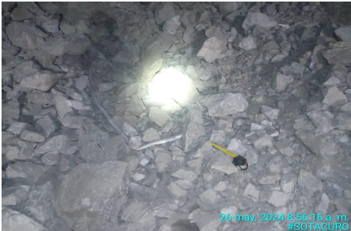
Figura 15. Granulometría post voladura, Cx620 Nv1850, escenario mejorado, Rx volcánica
