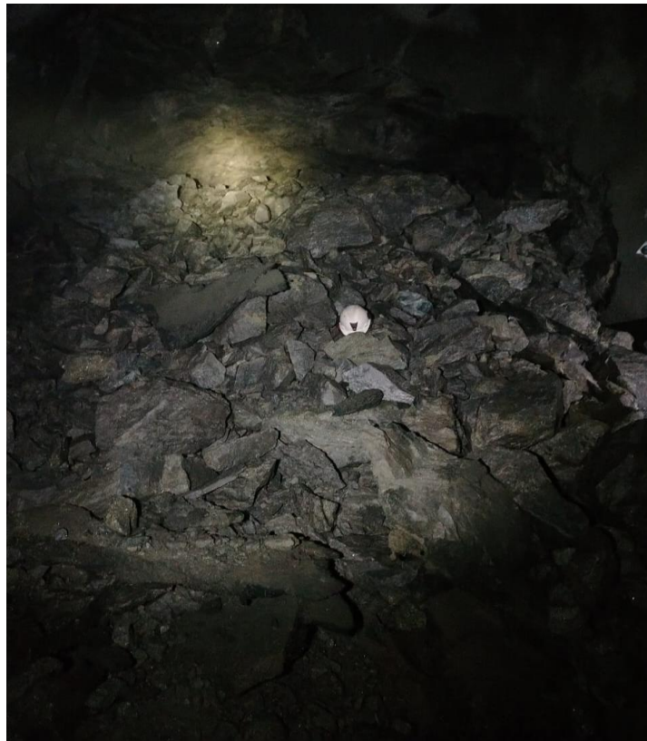
Figura 13. Granulometría post voladura, Cx020 Nv1850, escenario inicial, Rx volcánica
