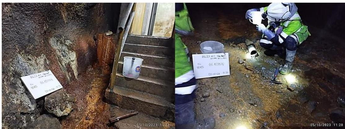
*Figura 17. Izquierda: aforo en GL1013N nivel 4085. Derecha: filtraciones de la GL 1035N nivel 3912*
