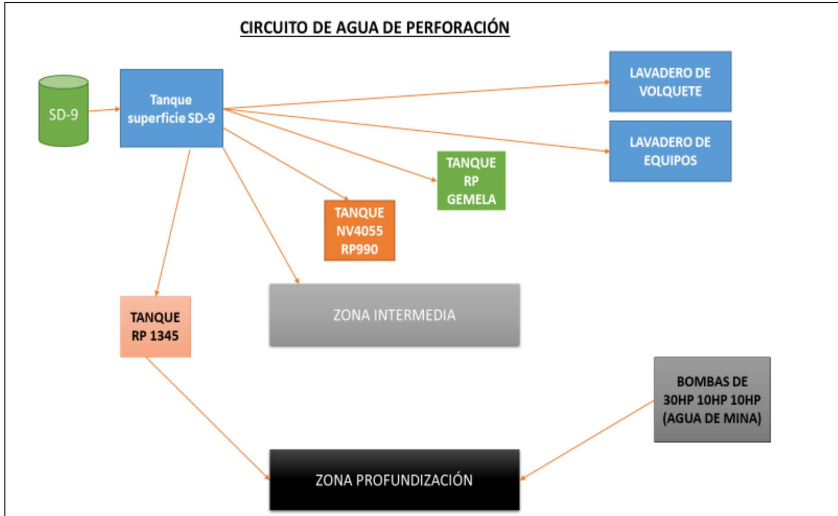
*Figura 28. Circuito agua de perforación.
