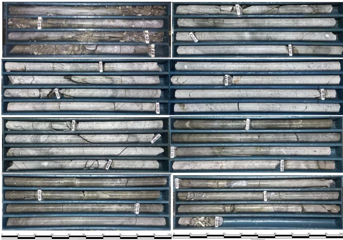
**Figura 12. Registro de cores, representando los tramos interceptados durante la perforación DDH-**
