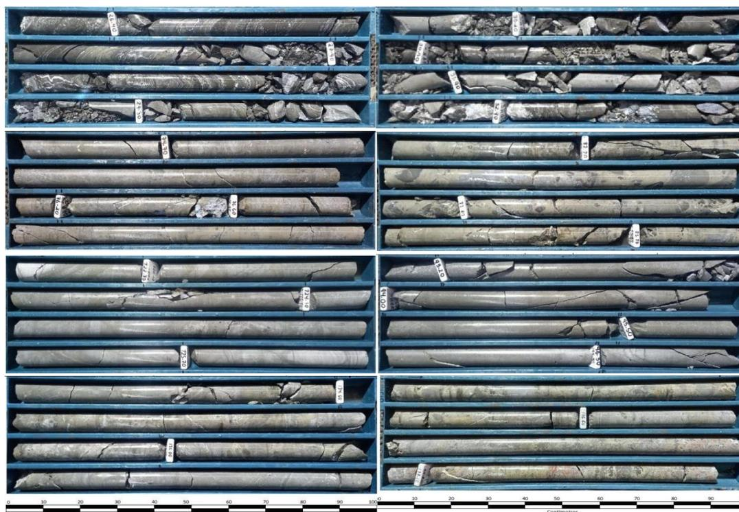
*Figura 10. Registro de cores, representando los tramos interceptados durante la perforación DDH-01-023*
