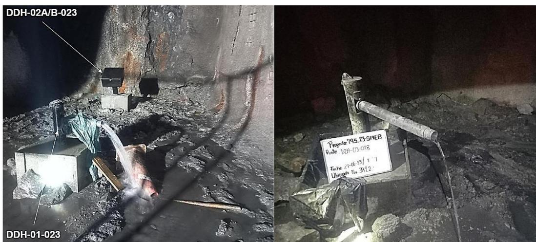
**Figura 13. Monumentación de piezómetros DDH-01-023, DDH-02A/B-023 y DDH-03-023**
