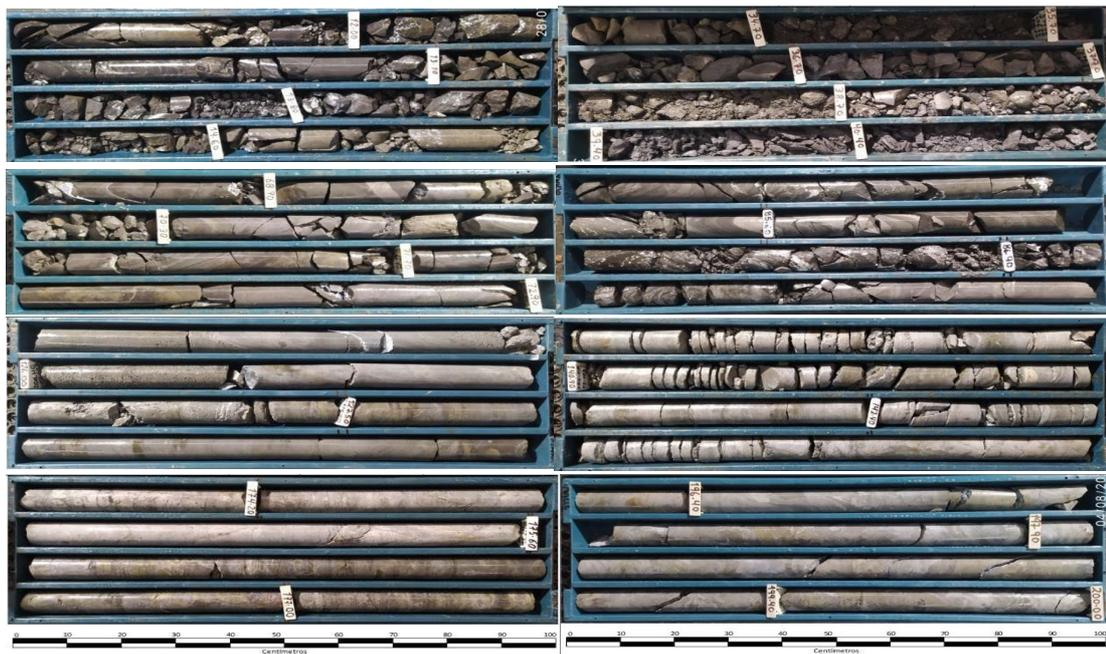
*Figura 11. Registro de cores, representando los tramos interceptados durante la perforación DDH-02-023*
