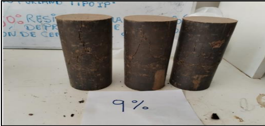
Figura 30 Ensayos a resistencia a la compresión
