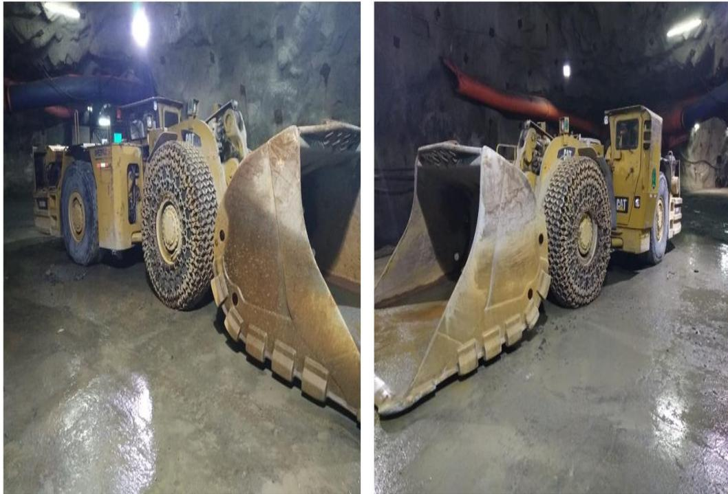
**Figura 23. Solución de cadenas protectoras en los neumáticos delanteros de los equipos**
