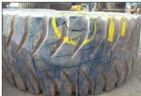
*Figura 15. Corte de un neumático en banda de rodado (11)*
