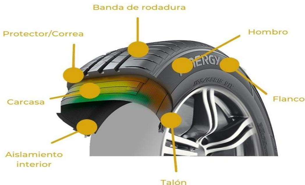
**Figura 9. Partes del neumático**
