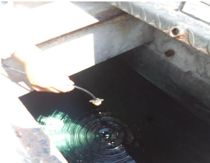
*Figura 20. Gotero autocompensante instalado.*
